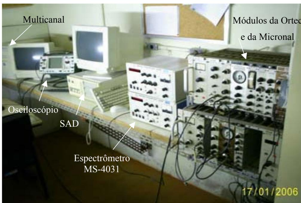
Figura III.2 – Conjunto de aquisição e análise de dados, dispostos sobre a bancada experimental
