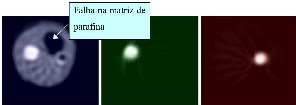
**Figura 5.2** - Imagens tomográficas das amostras de parafina preenchidas com soluções padrão. Esquerda: transmissão, centro: CTXRF - Zn (1000 µg g-1), direita: CTXRF - Se (1000 µg g-1).
