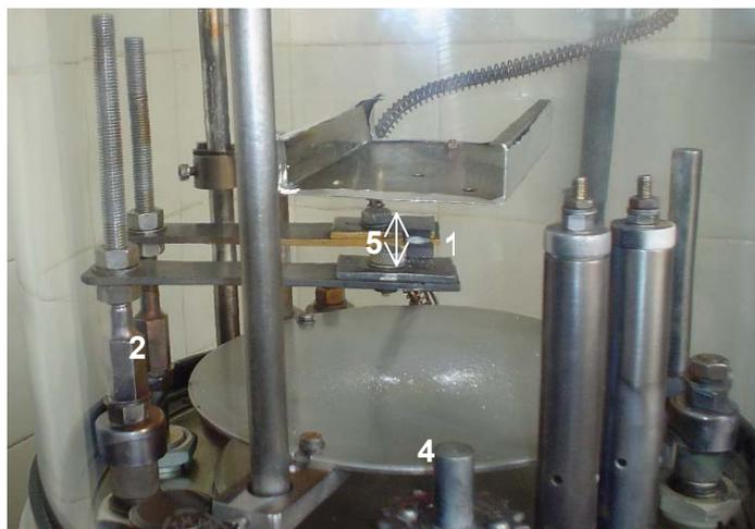
Figura III. 3 – Montagem experimental da evaporação: 1) cadinho, 2) suportes de aço, 3) suporte onde a folha de gadolínio é posicionada, 4) prato do evaporador, 5) distância cadinho-folha de alumínio.
