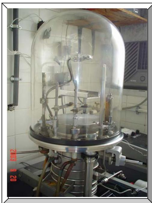
Figura III. 2 – Evaporador Resistivo Edward E306A (LACAM/ IF/ UFRJ)
