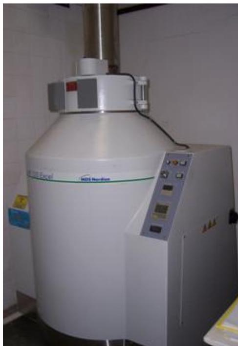
Figura III.3 – Irradiador Gammacell 220 da Nordion.
