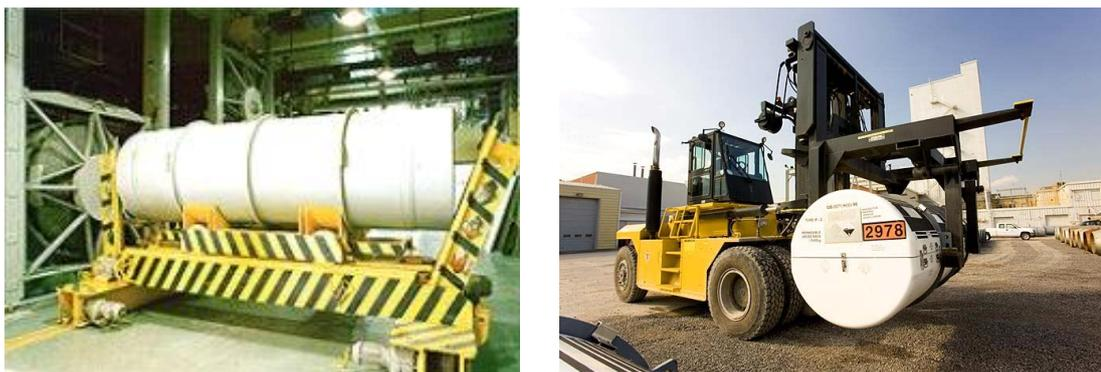
Figura 4.4 – Cilindro 48Y para UF<sub>6</sub> natural e empilhadeira de transporte
