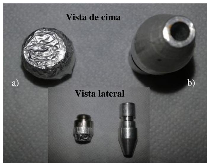
Figura 4.7 – Colimadores utilizados no tubo de raios X e detector, a) Colimador utilizado no tubo de raios X com filtro de TiO<sub>2</sub>, b) Colimador utilizado no detector.
