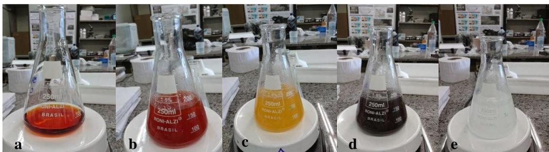
Figura 4.12 - Titulação para determinação do índice de iodo: (a) amostra com solução Wijs, (b) amostra com água e solução de KI, (c) amostra sendo titulada com tiosulfato de sódio, (d) adição do amido a amostra e (e) titulação com tiosulfato de sódio até o total desaparecimento da coloração.
