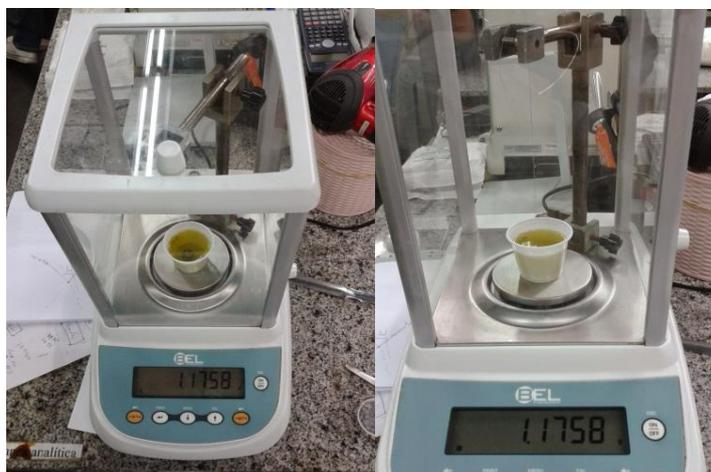
Figura 4.15 - Medida da massa para determinação da densidade.
