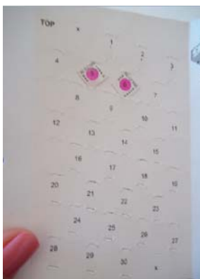
Figura 3.5: Cartão de dosímetro com os dosímetros 5 e 6 posicionados.
