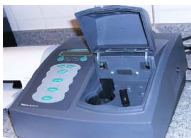
Figura 3.4: Fotografia do Espectrofotômetro GENESYS 20 [22]
