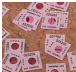
Figura 3.3: Fotografia dos dosímetros filme radiocrômico B3.
