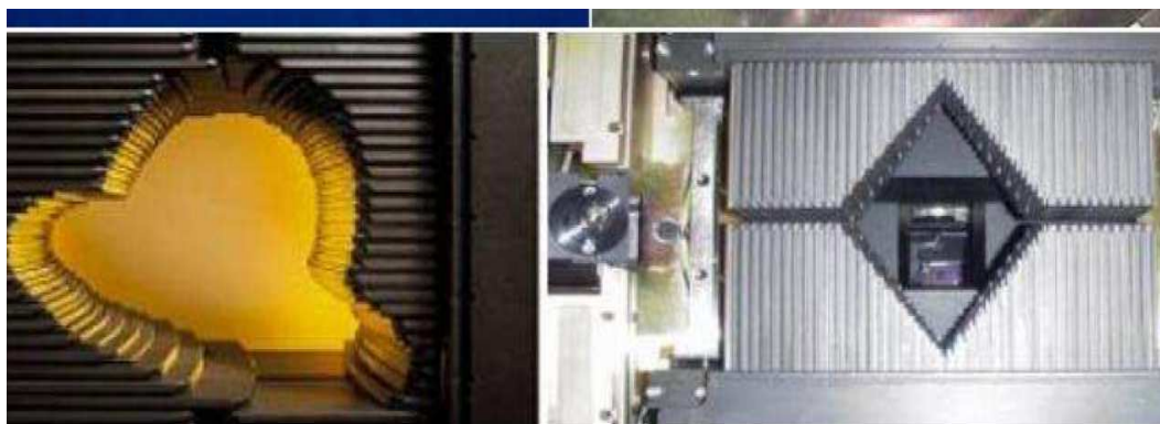
Figura 2.19 – Visão inferior do cabeçote de um acelerador e seus respectivos MLC's (SILVA JUNIOR, 2008).
