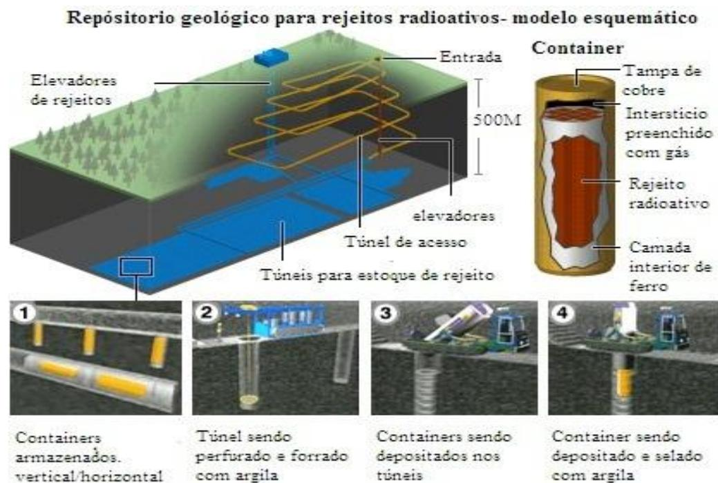
Figura 2.3: Diagrama de um repositório geológico em funcionamento. (POSIVA OY, 2000)
