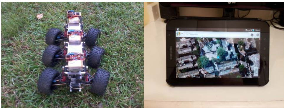
Figura 7.27 Controle do robô via Tablet com Andoid 2.2 e conexão 3G Fonte: Autor
