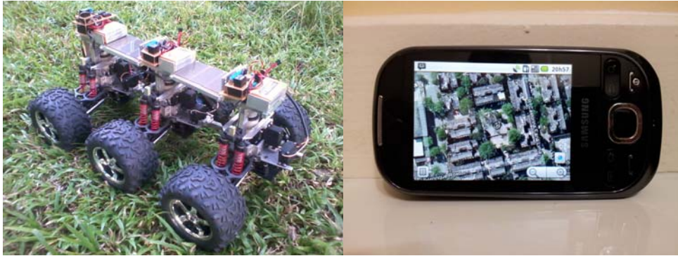
Figura 7.26 Controle do robô via celular Andoid 2.1 e conexão 3G Fonte: Autor
