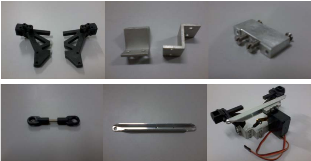
Figura 7.1 Componentes mecânicos do sistema de correção do centro de gravidade
