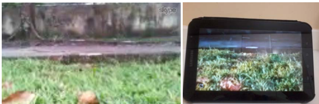
Figura 7.20 Controle do robô via Tablet com sistema Android e conexão 3G Fonte: Autor
