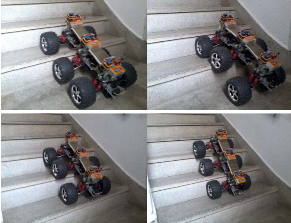
Figura 7.24 Subida de escada com controle por telefonia fixa
