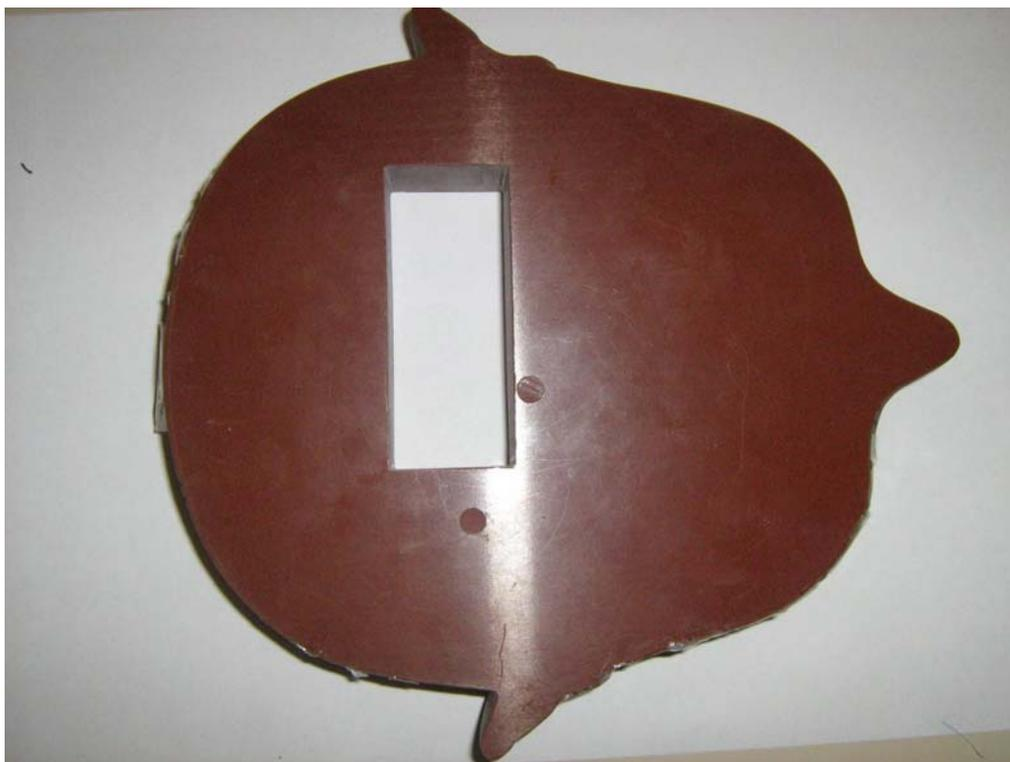
**Figure III.8** - Fatia confeccionada sem as respectivas estruturas. Visão do espaço de acoplamento dos detectores de radiação.
