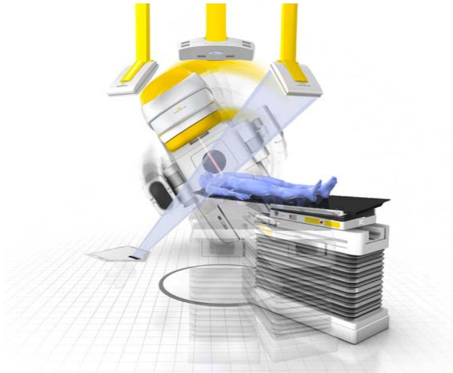
**Figura III.10** - Ilustração dos equipamentos que auxiliam no posicionamento do paciente. Raios-X e Emissor/Receptor infravermelho. Fonte: Bernd Seils, 2009, <http://www.flickr.com/photos/bernd-seils>.
