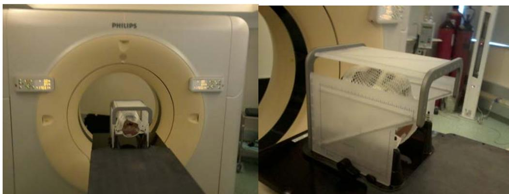
**Figura III.9** - Cabeça do simulador fixada à máscara e o sistema (caixa) de localização de coordenadas estereotáxicas submetidos a tomografia.
