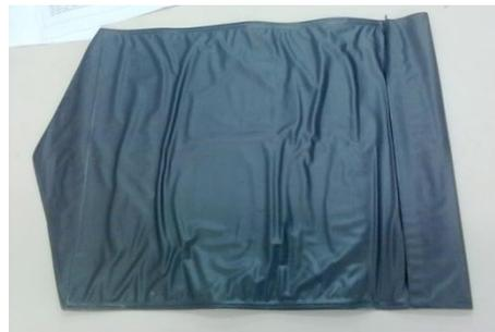
Figura 3.8 – Cassete flexível sem chumbo utilizado no ensaio.
