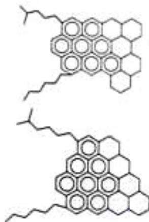
Figura 2.16: Representação da estrutura hipotética de um asfalteno (MARTIN, 2007).
