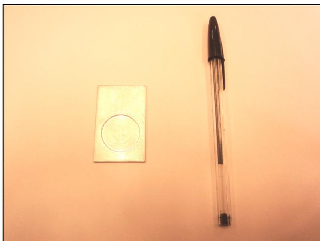
Figura 3.2: Porta-amostra de alumínio referente ao equipamento utilizado neste estudo.
