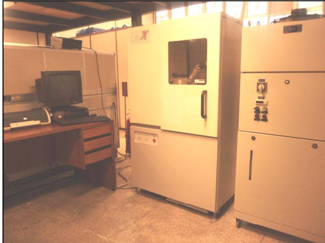
Figura 3.10: Equipamento completo, difratômetro XRD 6000, constituído de uma unidade principal (a) e um sistema computacional (b) e (c) um refrigerador (Laboratório de Instrumentação Nuclear).
