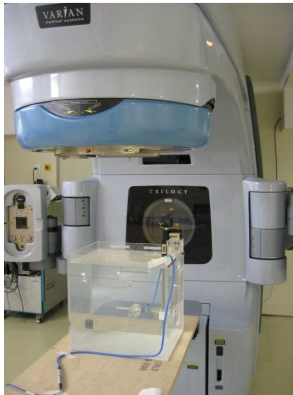
Figura 5. a) Arranjo experimental para dosimetria e medição dos casos teste.
