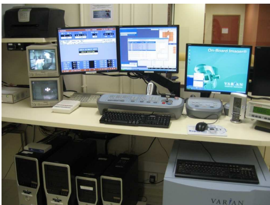
Figura 14. Sala de controle do acelerador Trilogy. No monitor central: programa ARIA, no monitor da esquerda: programa de controle operacional do acelerador.
