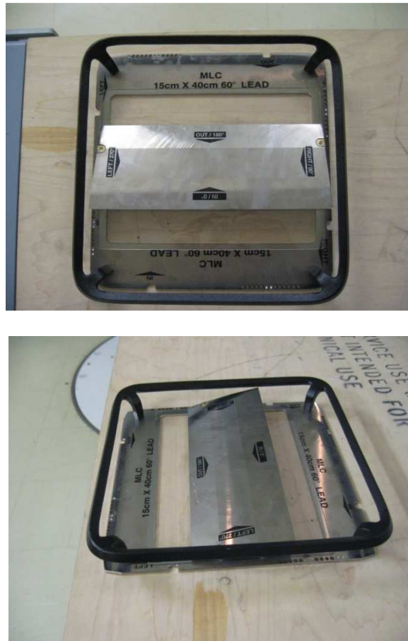
Figura 18. Filtro físico de 60°. Acessório do acelerador Trilogy.
