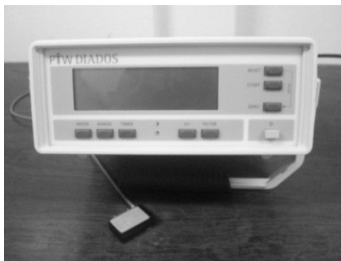
Figura 3.10: Sistema medidor PTW DIADOS (eletrômetro e detector).
