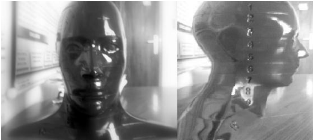
Figura 2.10: Arranjo de cabeça-pescoço do simulador Alderson-Rando [64].
