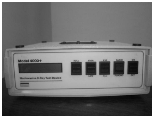
Figura 3.3: Dispositivo de teste não-invasivo: Victoreen, Modelo 4000M+.
