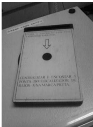
Figura 3.5: Kit postal contendo um filme odontológico em seu interior para medição do diâmetro do campo [29,45].
