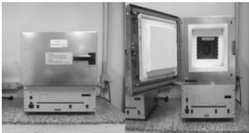
Figura 3.9: Forno PTW-TLD do SEMEX/IRD.
