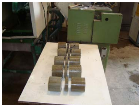
Figura 3.10: Fatias extraídas das partes centrais dos corpos de prova cilíndricos de concreto.
