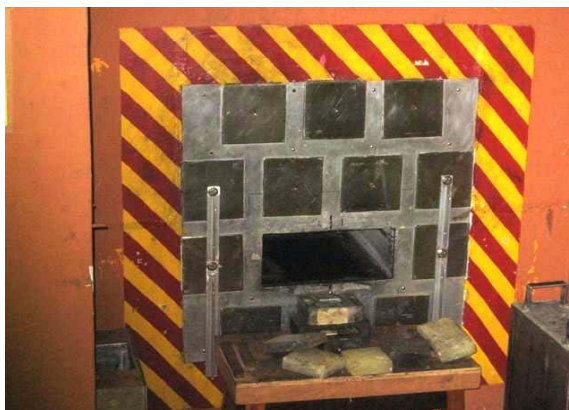
Figura 3.14: Canais de irradiação localizados na coluna térmica do reator Argonauta, tendo no centro o canal J-9.
