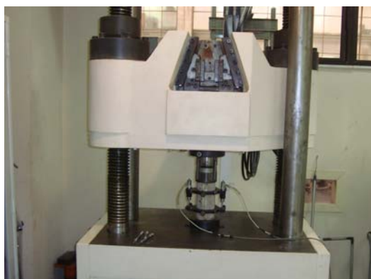
Figura 3.8: Prensa SHIMADZU UH F 1000 Usada para Submeter os Corpos de Prova a Diferentes Compressões.
