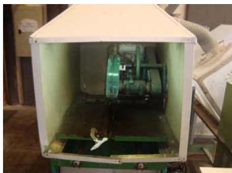
Figura 3.9: Foto da serra elétrica usada para o corte dos blocos cilíndricos de concreto especial.
