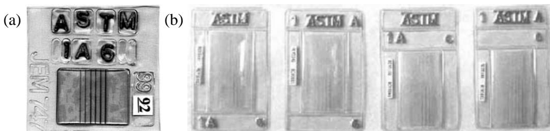
**Figura 3.9** – Em (a) tem-se o IQI de arame, e em (b) os quatro estilos de acordo com o padrão da ASTM.
