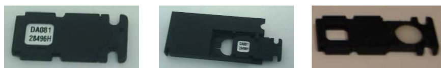
Figura 1.1. Dosímetro OSL estudado. Em destaque: sensibilidade 0,81 indicada pelo fabricante e identificação alfanumérica 28496H; adaptador utilizado no ato da leitura do dosímetro; dosímetro OSL aberto expondo o \text{Al}_2\text{O}_3:\text{C} , estado em que permanece dentro da leitora para que o estímulo óptico seja possível.
