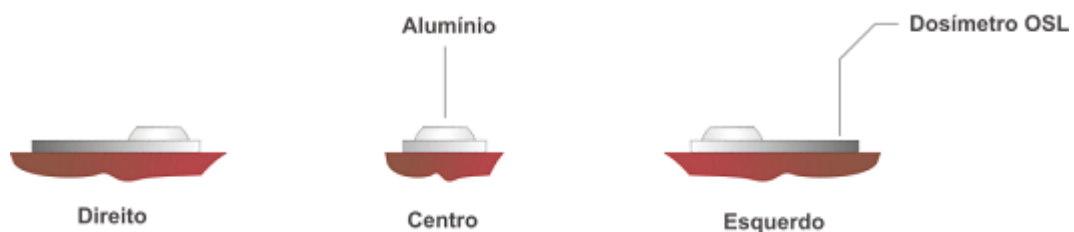
Figura 3.4. As três posições do dosímetro OSL sobre o simulador de água sólida.
