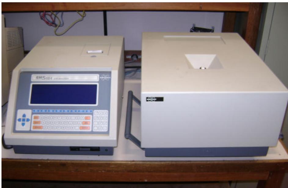
Figura III-4: Espectrômetro RPE Bruker EMS 104
