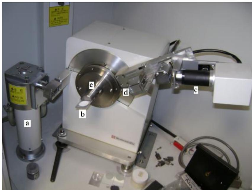
Figura III-VI: Difratorômetro Shimadzu XRD 6000. Em (a), temos o tubo de raios x, (b) o porta amostra, (c) o detector, (d) o braço  $2\theta$  e (e) o braço  $\theta$ .
