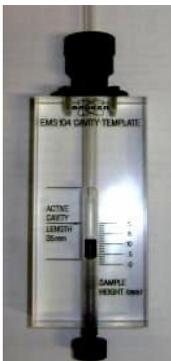
Figura III-V: Amostra no simulador de cavidade
