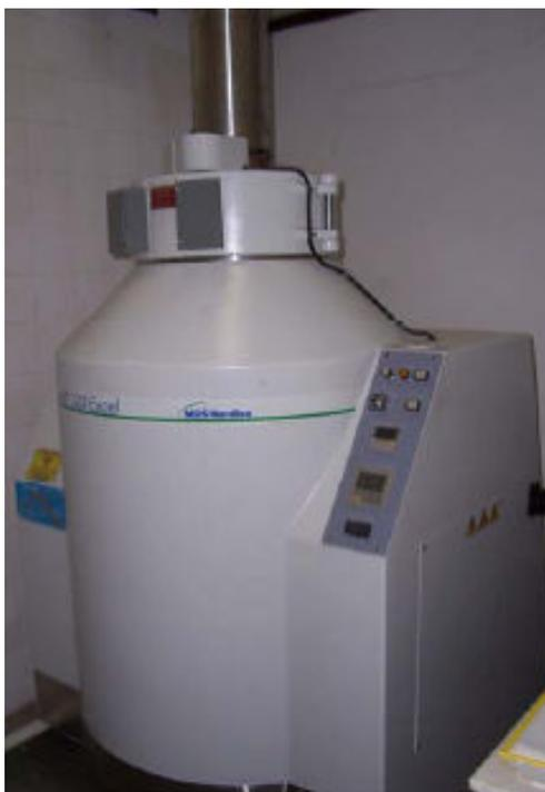
Figura III-3: irradiador Gammacel 220 Excel
