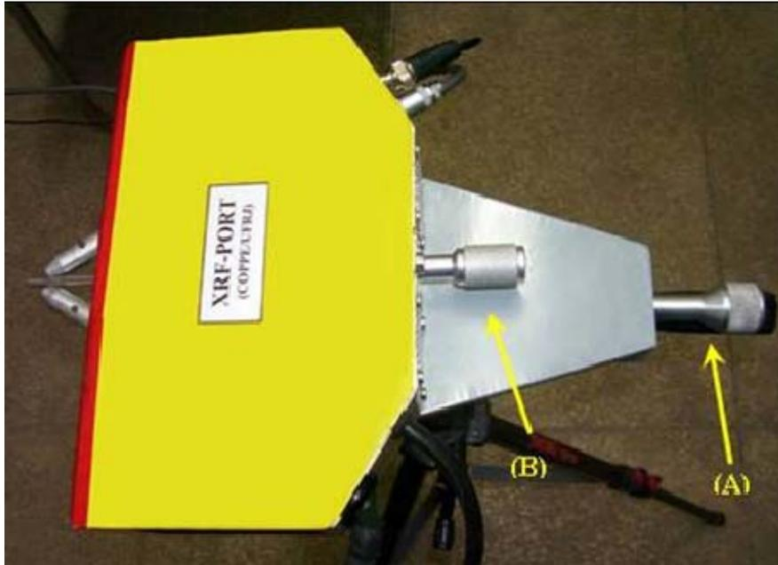
**Figura 4.13.** Sistema de posicionamento horizontal do módulo (A) e sistema de posicionamento em relação à amostra (B).
