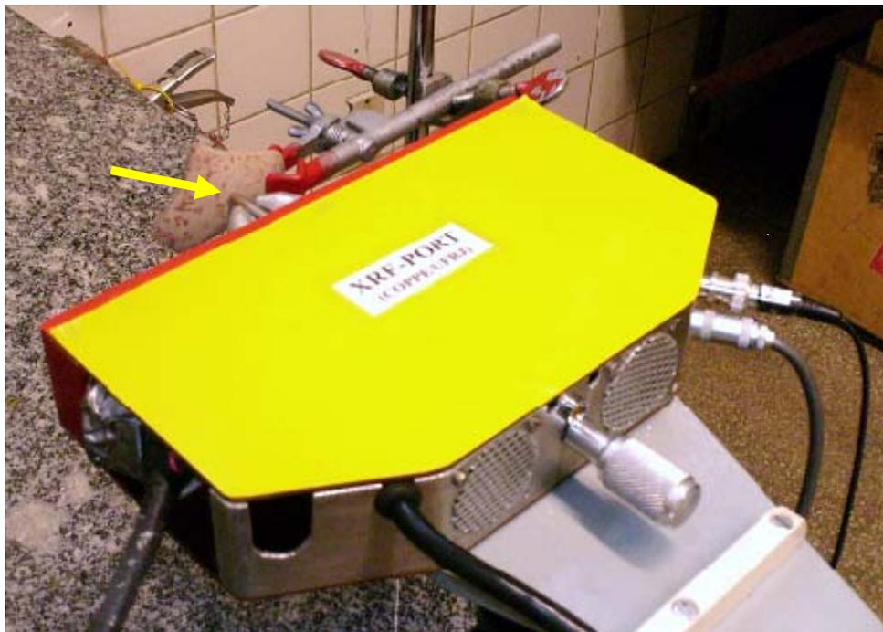
**Figura 4.10.** Sistema de posicionamento em relação à amostra.
