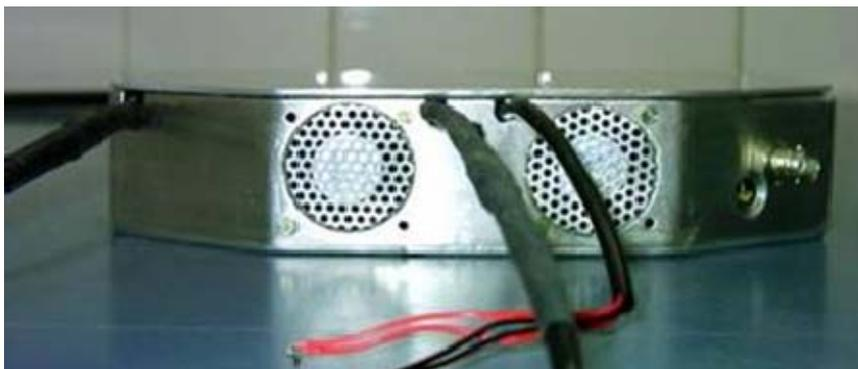
**Figura 4.14.** Parte traseira do módulo. Visão da parte externa do sistema de refrigeração.
