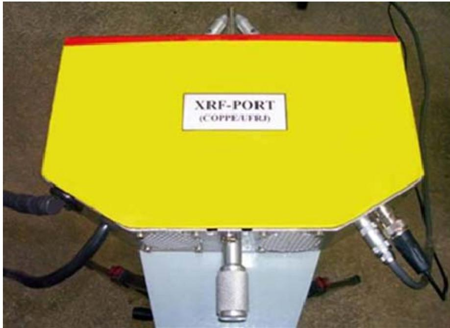
**Figura 4.6.** Parte externa do sistema portátil de XRF.
