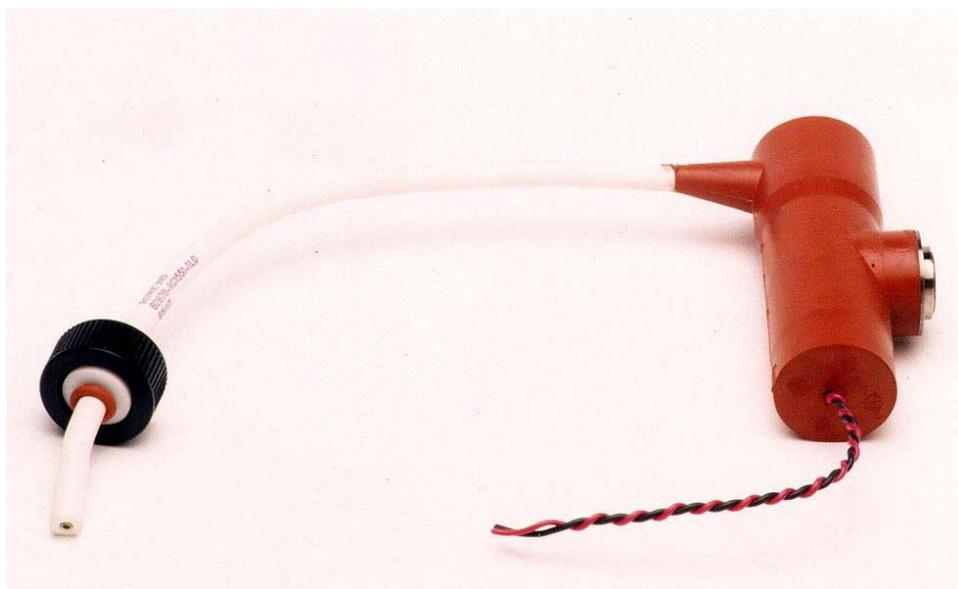
**Figura 4.1** — Tubo de raios X modelo.TF 3005 da Oxford Instrumentes Inc.
