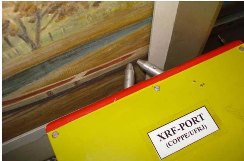
**Figura 4.23** — Posicionamento do sistema fonte-detector em um quadro.
