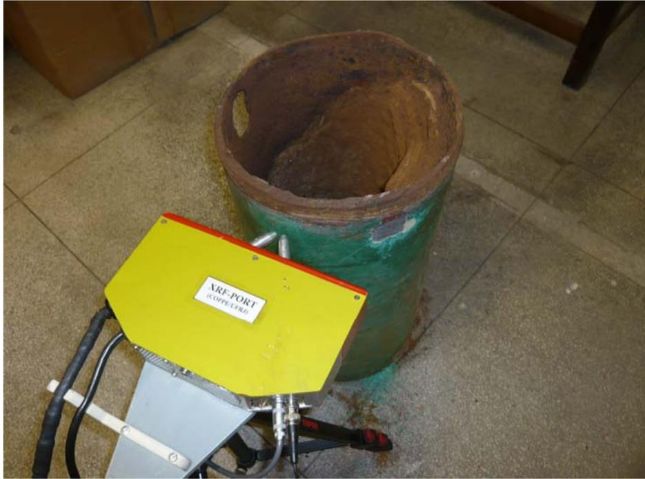
Figura 5.24 – Sistema realizando medidas na camada externa da tubulação.
