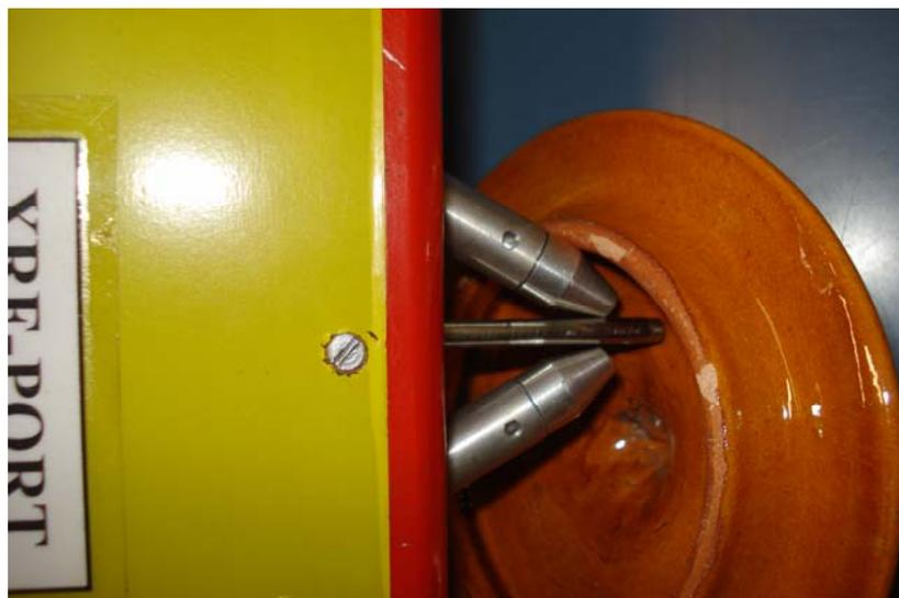
**Figura 4.22** — Posicionamento do sistema fonte-detector na tampa da chaleira.
