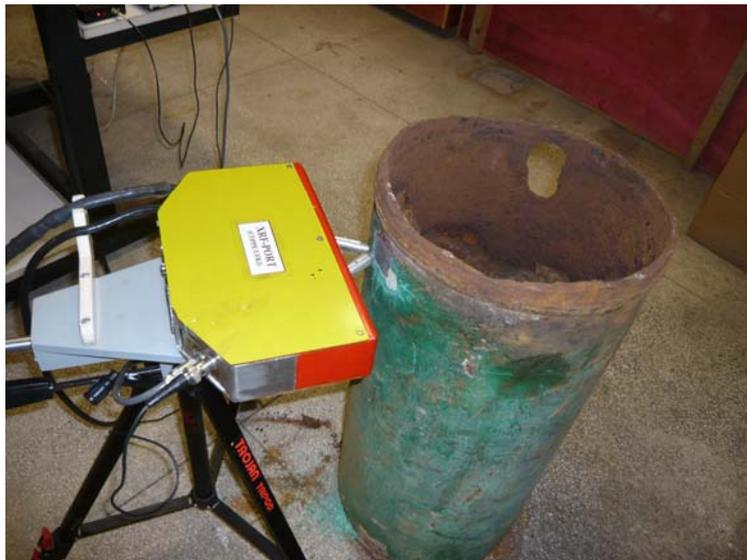
**Figura 5.28** – Sistema realizando medidas na parede externa sem o revestimento.
