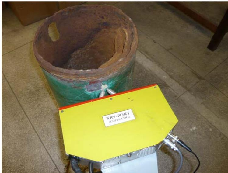
Figura 5.26 – Sistema realizando medidas na segunda camada externa.
