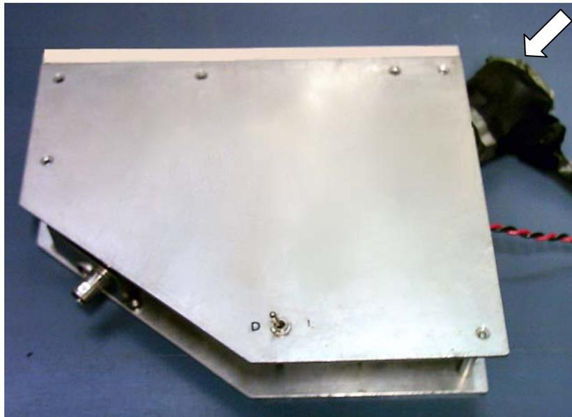
**Figura 4.9** — Projeto do módulo inicial tubo-detector vista externa.
