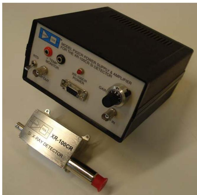
**Figura 4.3** — Detector modelo Si-PIN XR-100CR e PX2T/CR, Amptek.
