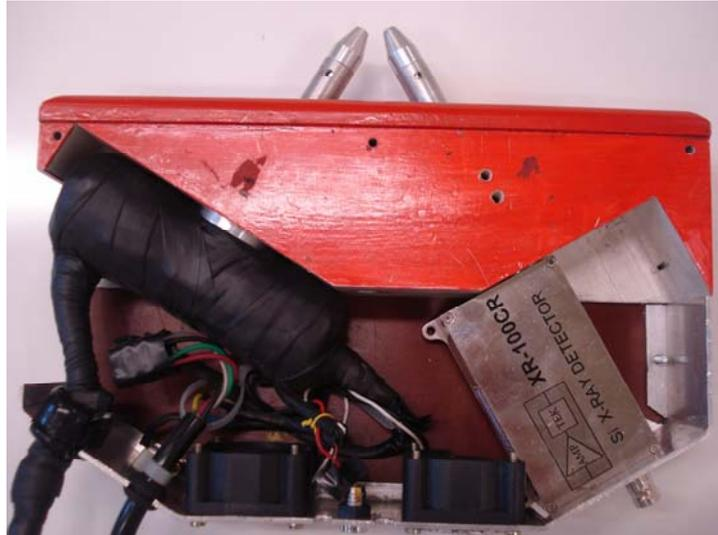
**Figura 4.16** — Vista superior interna da montagem do sistema fonte-detector.
