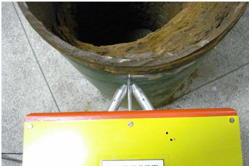
**Figura 4.20** — Posicionamento do sistema fonte-detector com a amostra.
