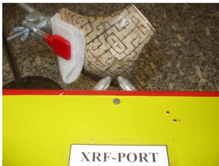
**Figura 5.18** – Sistema medindo uma das amostras de tangas de cerâmica Marajoara
