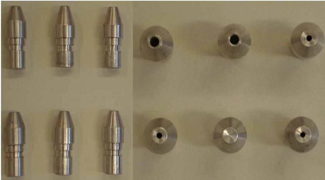
**Figura 4.25** — Colimação final do tubo de raios X e detector
