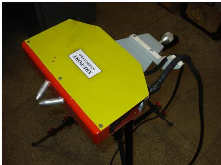
**Figura 4.17** — Vista em perspectiva da montagem do sistema fonte-detector.
