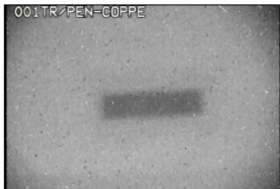
Figura V.1: NRTR com a utilização da tela cintiladora conversora de nêutrons importada, NE-425
