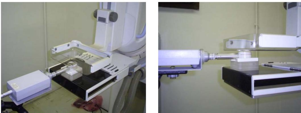
Figura 3.5 Posição da câmara de ionização no mamógrafo
