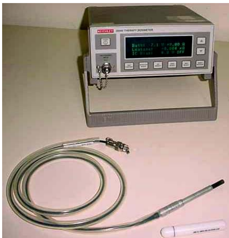
Figura 3.10: Conjunto dosimétrico de referência: câmara de ionização IC70 e eletrômetro.
