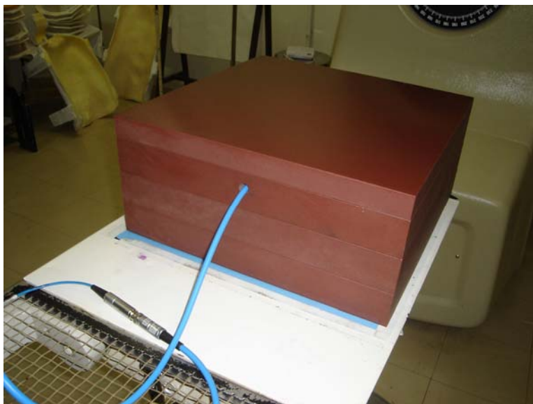
Figura 3.19: Câmara de ionização posicionada dentro do simulador de água sólida, na linha central, na profundidade de dose máxima ( d_{m\acute{a}x} ).
