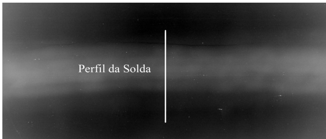
Figura IV.38 – Imagem radiográfica do cordão de solda da amostra 2, sob a condição de tubo sem água e com simulação de revestimento
