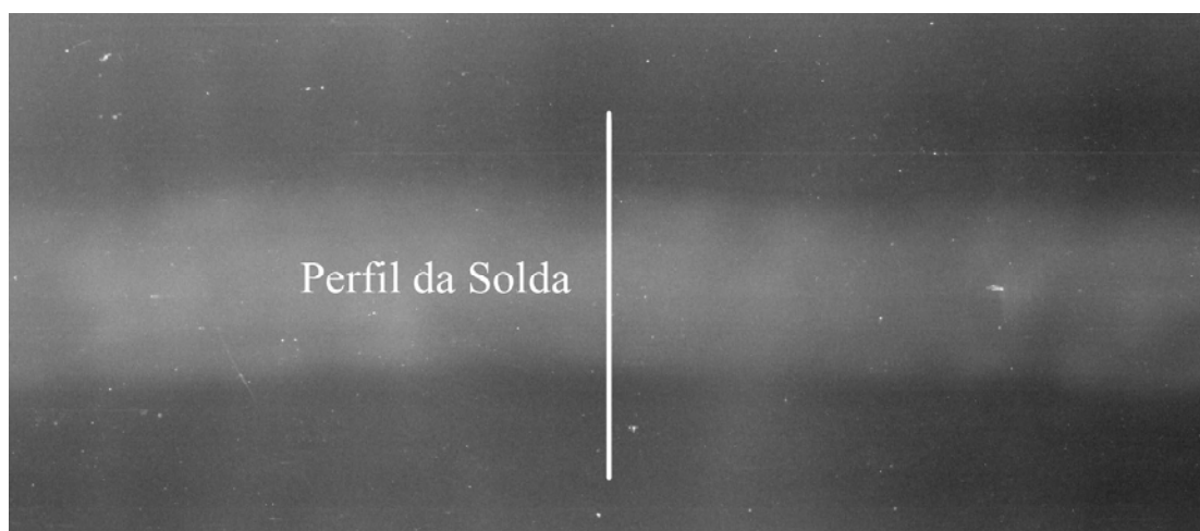
Figura IV.42 – Imagem radiográfica do cordão de solda da amostra 2, sob a condição de tubo com água e com simulação de revestimento
