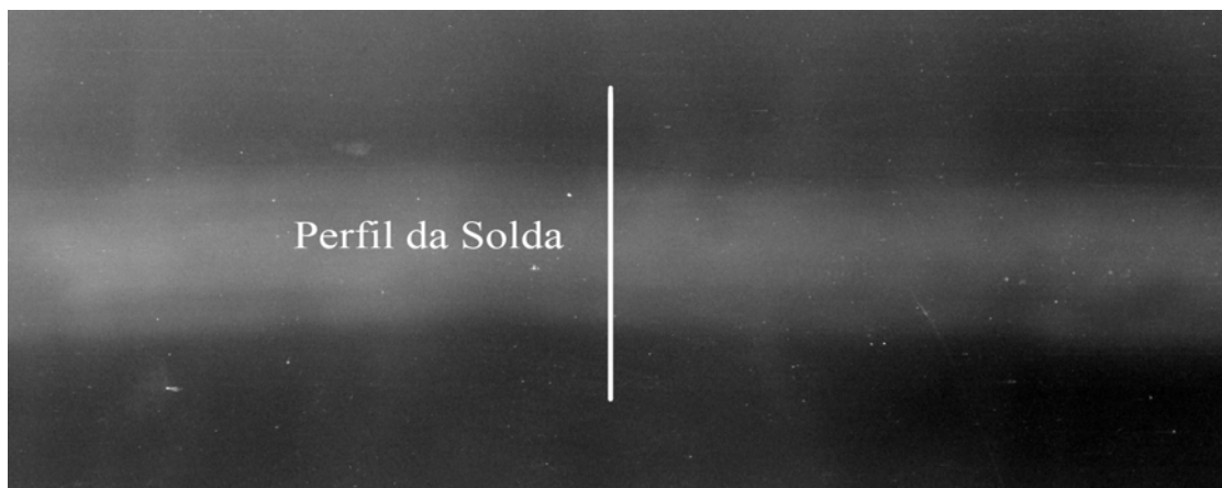
Figura IV.40 – Imagem radiográfica do cordão de solda da amostra 2, sob a condição de tubo com água e sem simulação de revestimento
