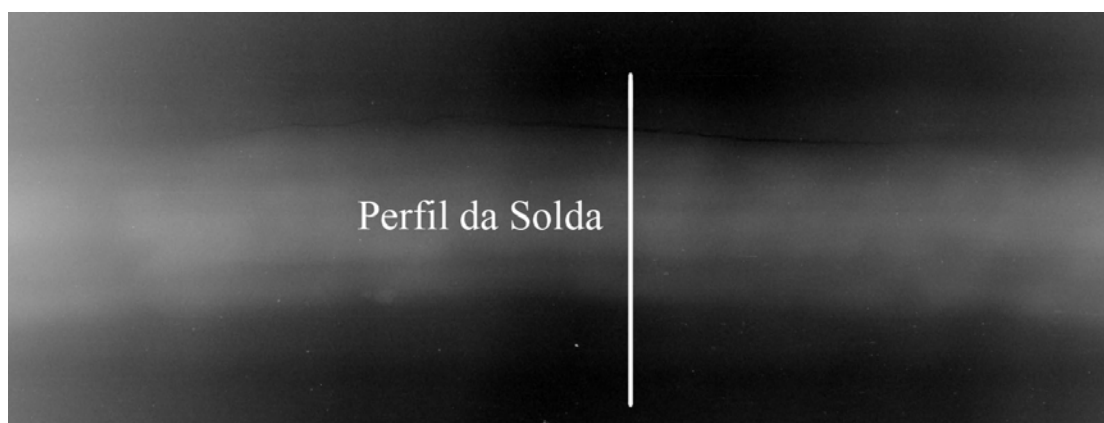
Figura IV.36 – Imagem radiográfica do cordão de solda da amostra 2, sob a condição de tubo sem água e sem simulação de revestimento
