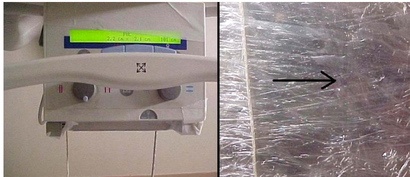
Figura 3.10 – À esquerda, câmara de ionização posicionada sob o sistema de colimação do feixe do tubo de raios X. À direita, indicação por uma seta da cruzeta com o ponto central da câmara coincidindo com o centro da cruz do sistema de colimação do tubo para passagem do feixe principal dos raios X.
