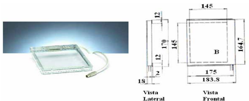
Figura 3.7 – À esquerda, câmara de ionização tipo 57523 (tamanho B) com conector; à direita, apresentação da câmara em duas vistas (lateral e frontal) com dimensões cotadas em milímetros (PTW Freiburg, 1998).
