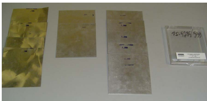
Figura 3.4 – Filtros de alumínio empregados para realização do teste da camada semi-redutora, da marca Victoreen - Nuclear Associates.
