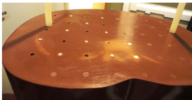
Figura 2.13 – Fatia do fantoma Alderson Rando com TLDs e orifícios [62].
