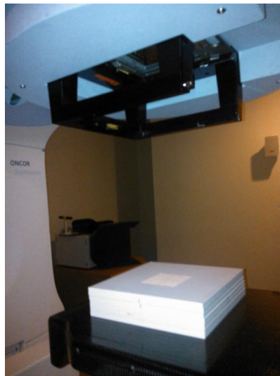
Figura 3.5 – Arranjo experimental para caracterização do TLD com uso de placa sólida.
