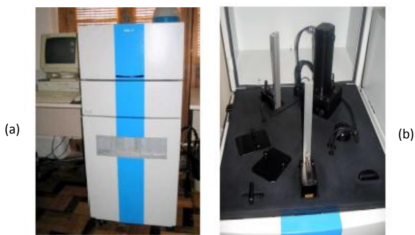
Figura 3.4 – Imagens da Leitora de TLDs Fimel PCL3 do SQRI [69]. (a) vista externa; (b) vista do interior da leitora, onde se posiciona o carregador de TLDs.
