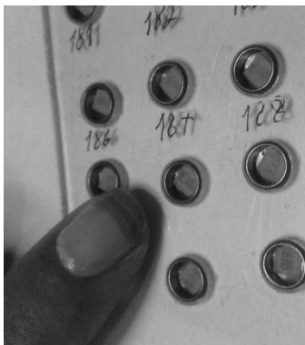
Figura 3.2 – TLD-100 dentro da copela.
