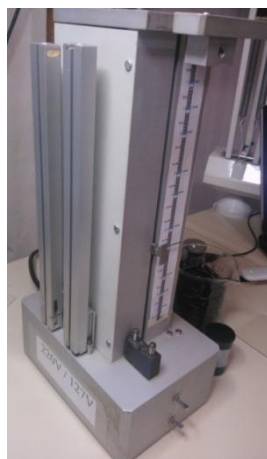
Figura 3.3 – Elevador utilizado para empilhar as copelas.
