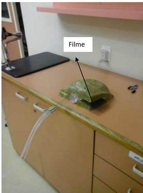
**Figura 3.26** – Arranjo experimental de irradiação do filme na simulação do tratamento de canal vaginal.
