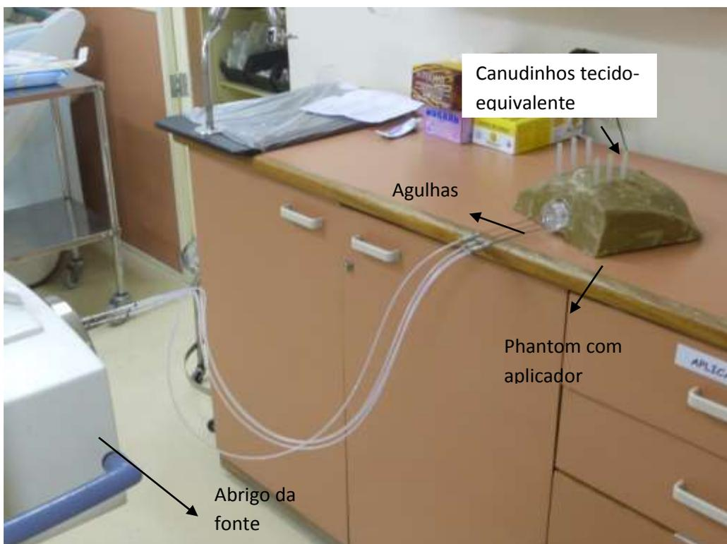
**Figura 3.14** – Arranjo experimental da irradiação do tratamento de canal anal. Observe as agulhas na parte inferior do aplicador.
