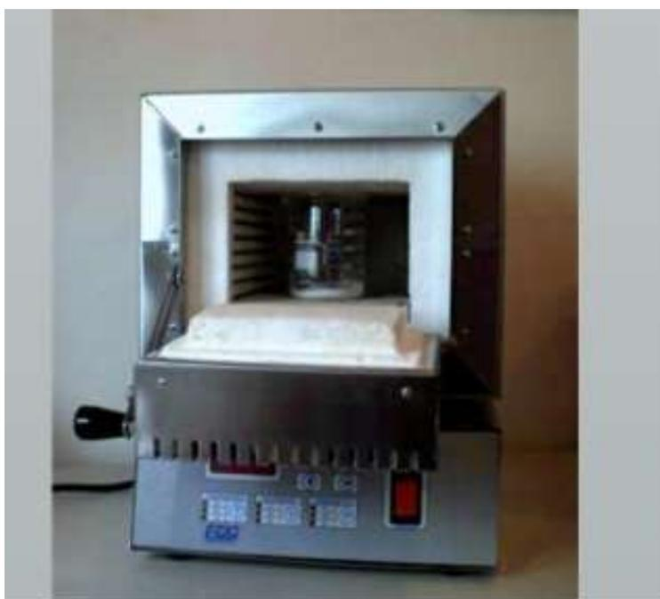
**Figura 3.18**– Forno para tratamento térmico do TLD100 em pó.
