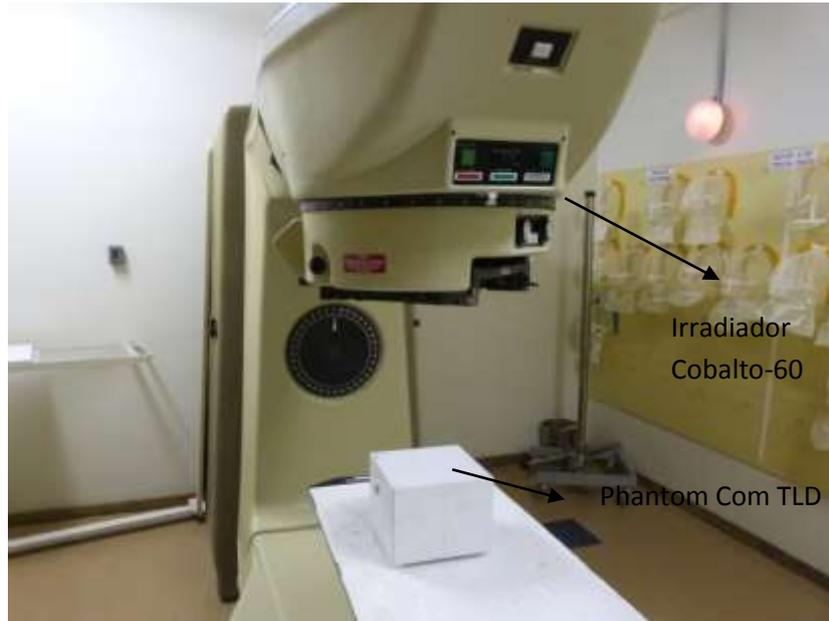
**Figura 3.21** – Arranjo experimental de calibração do TLD e do sistema TL com o irradiador de  $\text{Co}^{60}$ .
