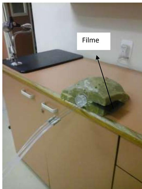
**Figura 3.25** – Arranjo experimental de irradiação do filme na simulação do tratamento de canal anal.
