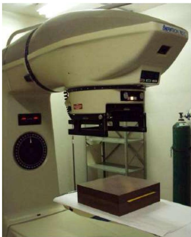
**Figura 3.22** – Arranjo experimental de calibração do filme radiocrômico. Observe que o filme foi colocado em um envelope para chamar a atenção do posicionamento do mesmo, mas durante a irradiação o filme não estava envelopado.
