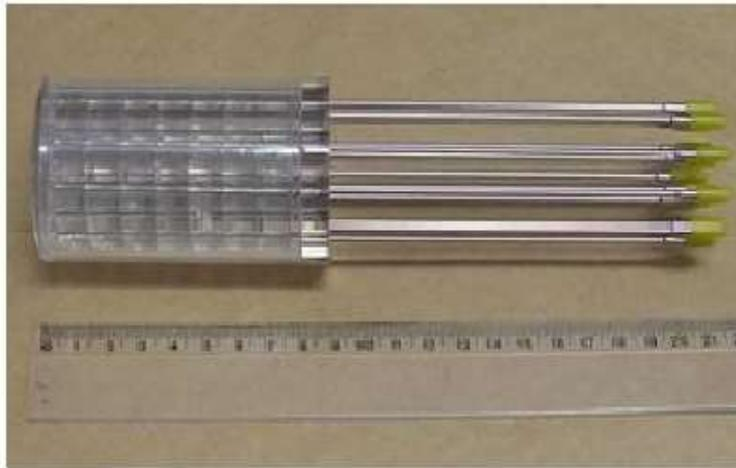
**Figura 3.1** – Aplicador com as agulhas e uma régua mostrando o seu comprimento.
