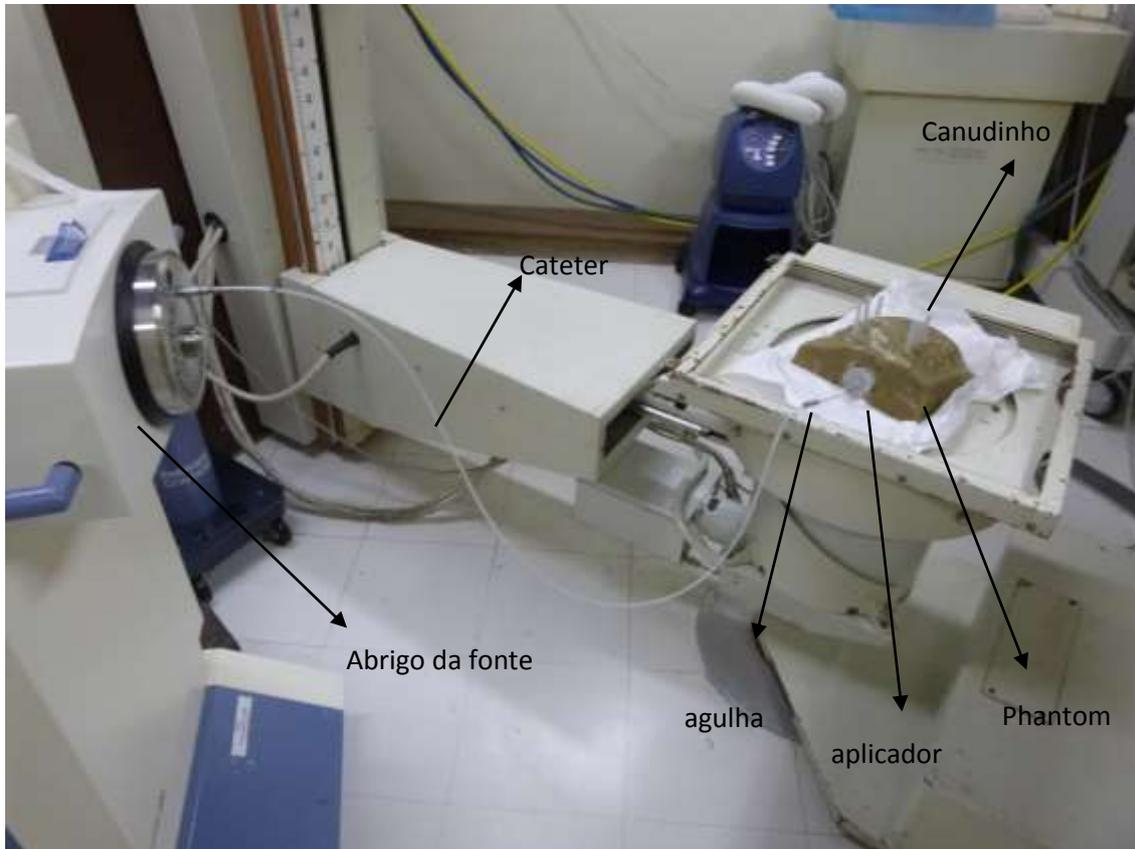
**Figura 3.12** – Arranjo experimental da irradiação do tratamento de endométrio.
