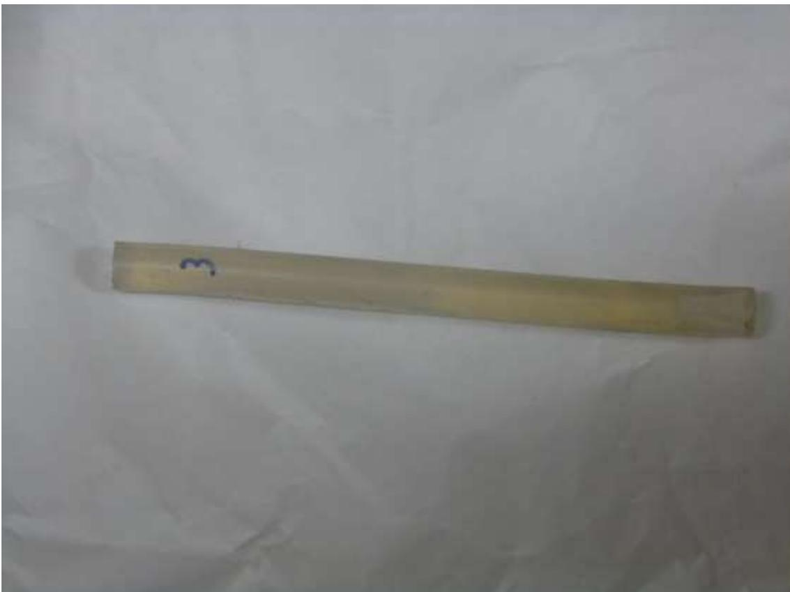
**Figura 3.5** – Canudo de borracha (tecido equivalente) para preenchimento acima dos TLD.
