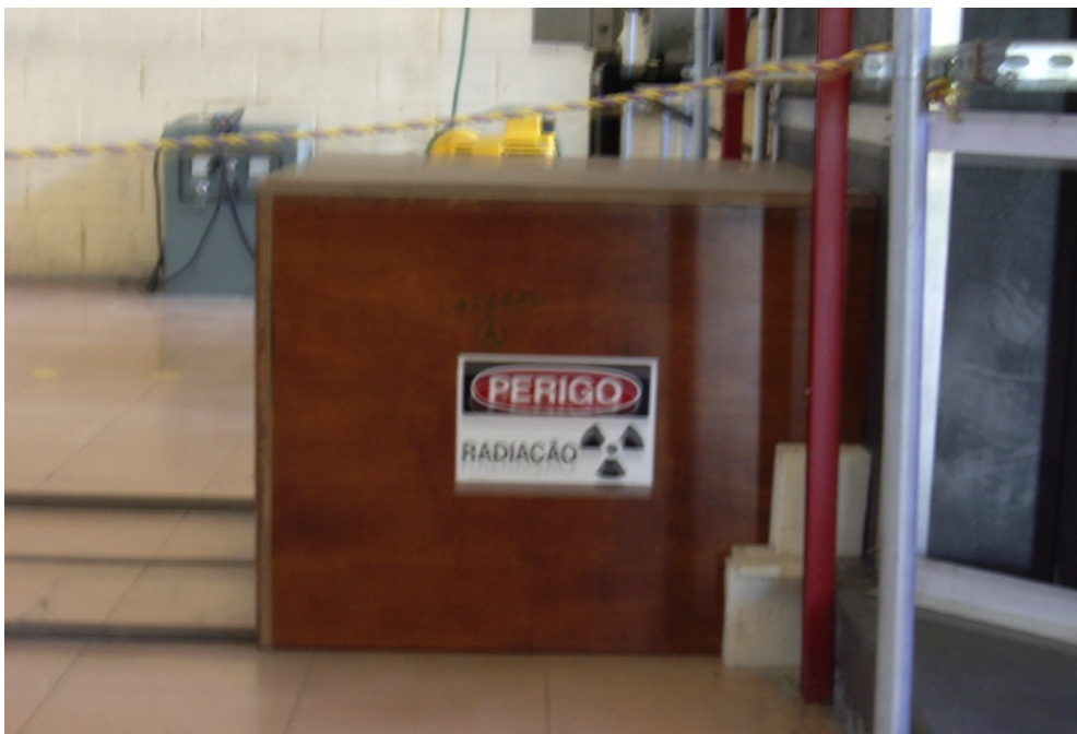
Figura 3.2-5 Blindagem da fonte externa de nêutrons
