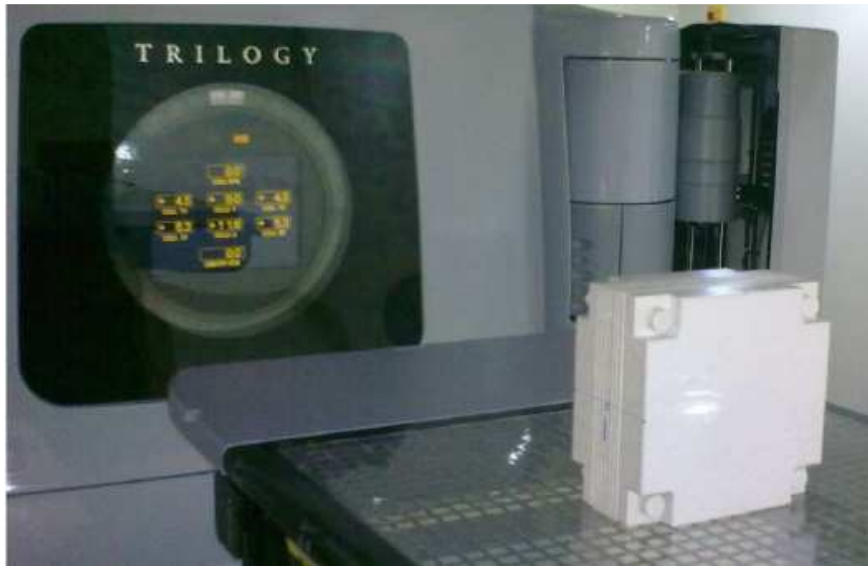
Figura 3.12 Fantoma para controle de qualidade em IMRT em posição de irradiação no acelerador linear Trilogy.
