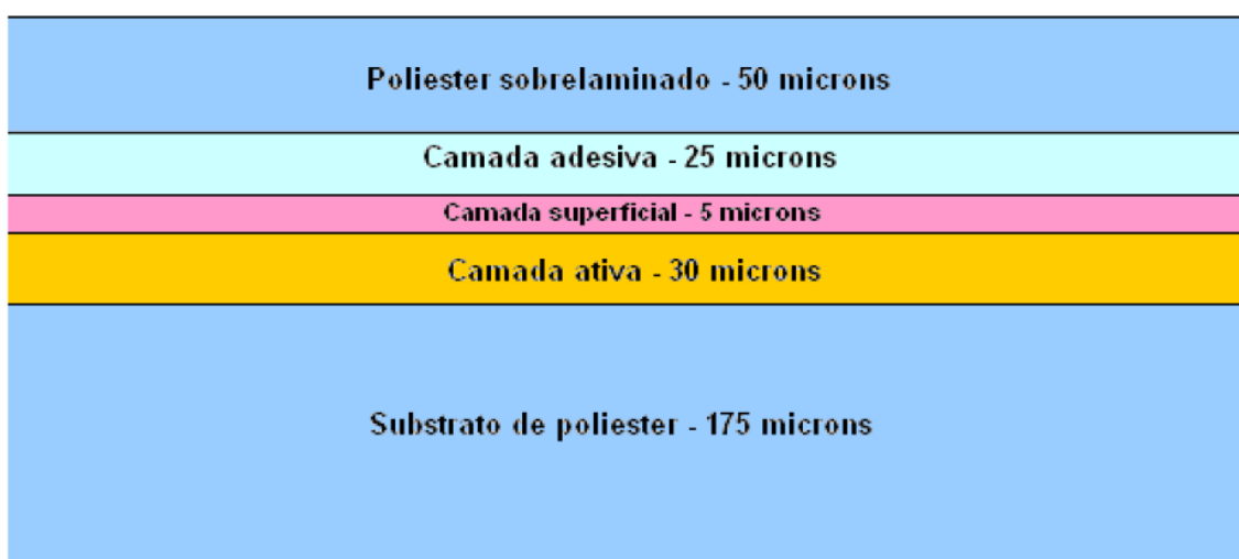
Figura 2.8 Configuração do filme Gafchromic® EBT2[3].
