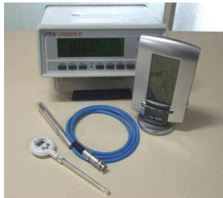
Figura 3.3 Conjunto dosimétrico (eletrômetro e câmara de ionização cilíndrica), termômetro e barômetro digitais.
