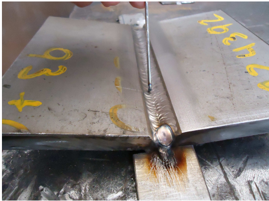
Figura 5.20: Corpo de prova a com alguns passe de solda e deformação angular da corpo de prova 1
