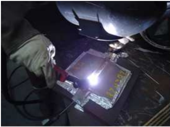
Figura 5.19: Soldagem GTAW, Corpo de prova 1 com um passe de solda.
