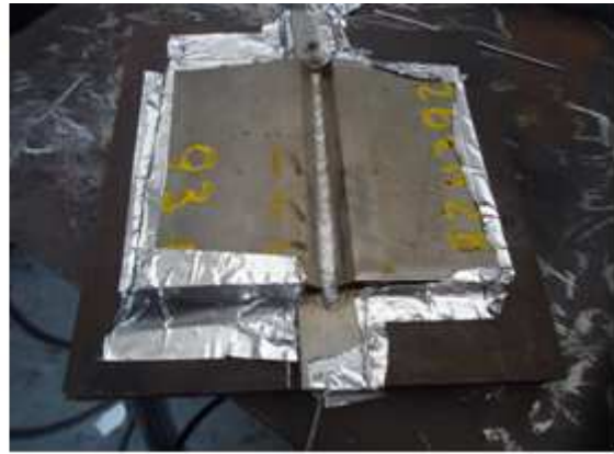
Figura 5.19: Soldagem GTAW, Corpo de prova 1 com um passe de solda.
