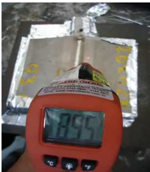
Figura 5.21: Medição da temperatura como o pirômetro ótico no cordão de solda e ZTA
