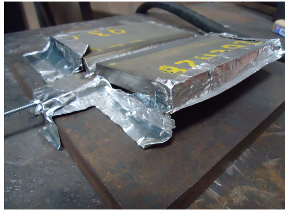
Figura 5.20: Corpo de prova a com alguns passe de solda e deformação angular da corpo de prova 1
