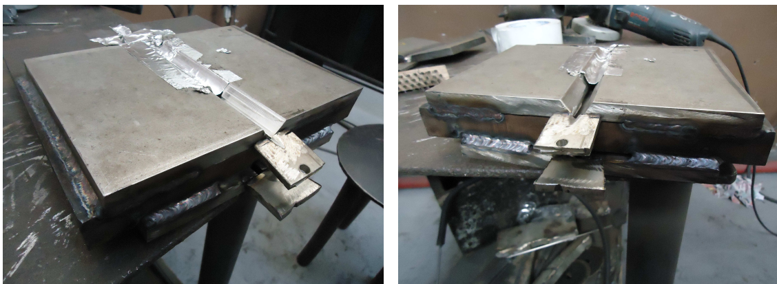
Figura 5.18: Preparação das chapas para a soldagem – Soldagem GTAW.
