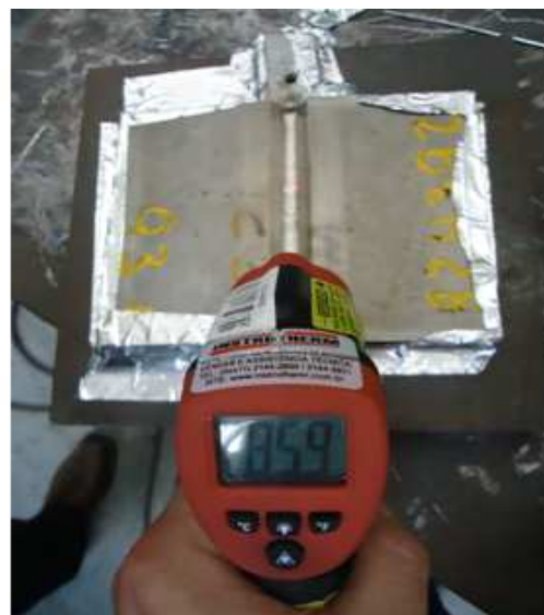
Figura 5.21: Medição da temperatura como o pirômetro ótico no cordão de solda e ZTA
