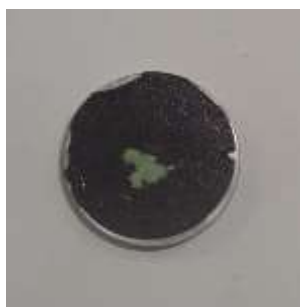
Figura 4.18. Pigmento em pó aderido a fita dupla face do porta-amostra do SEM-EDS.
