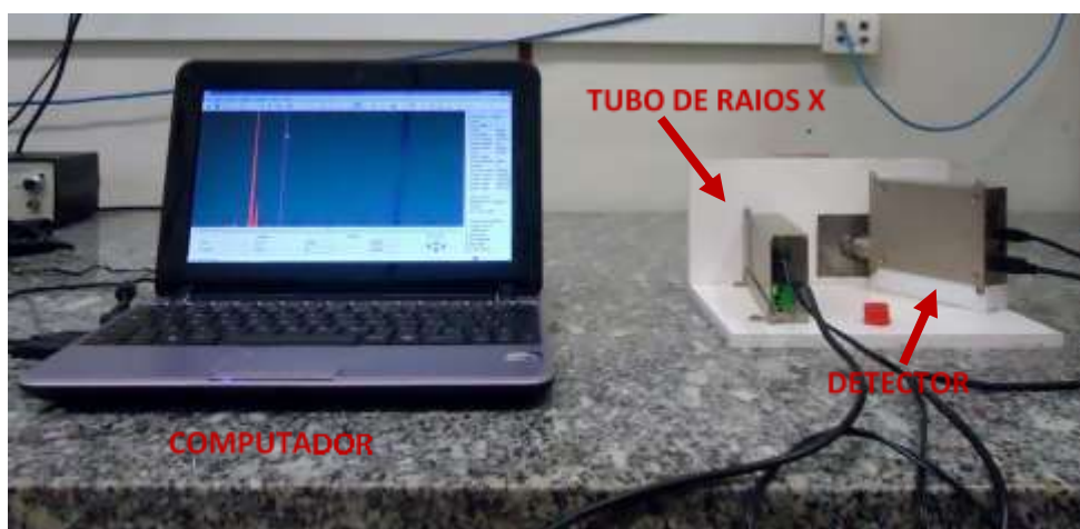
Figura 4.1. Sistema portátil de XRF utilizado nas análises.
