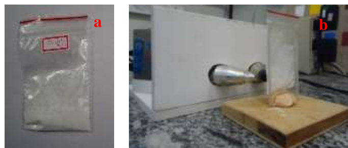
Figura 4.17. (a) Amostra de pigmento em pó; (b) sistema de XRF posicionado para análise.
