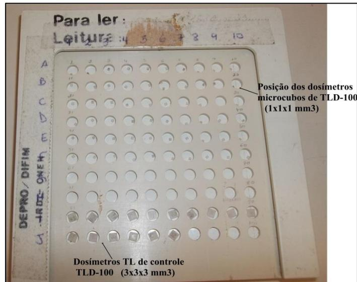
**Figura 18:** Porta-dosímetro com tampa de acrílico.
