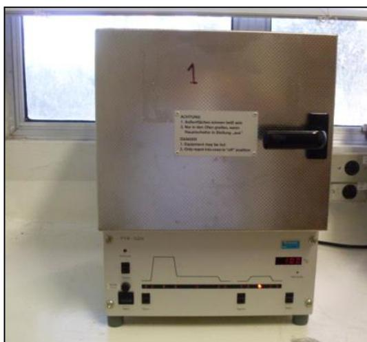
**Figura 17:** Forno PTW-TLDO utilizado para o tratamento térmico dos TLDs.
