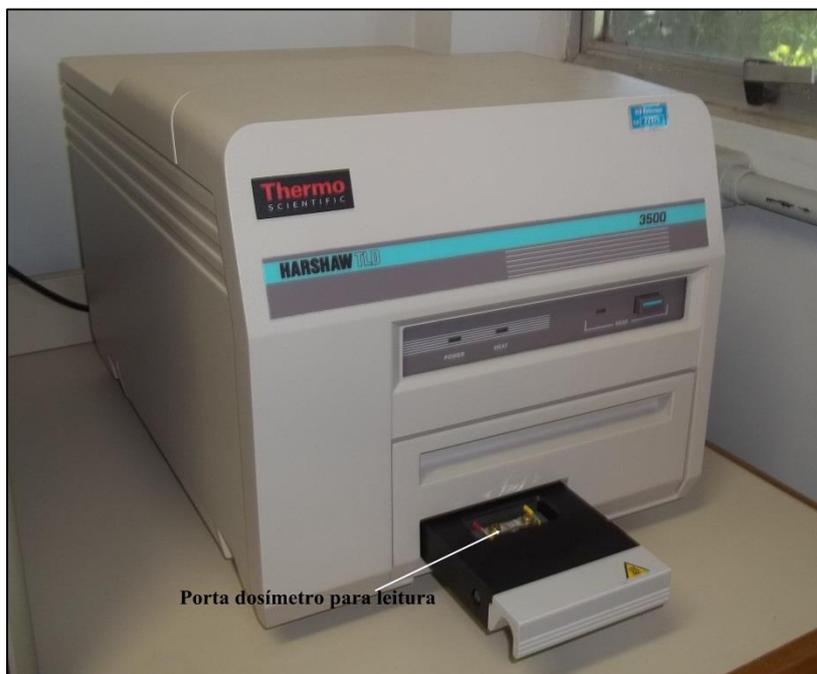
Figura 20: Leitora de TLDs Harshaw 3500.
