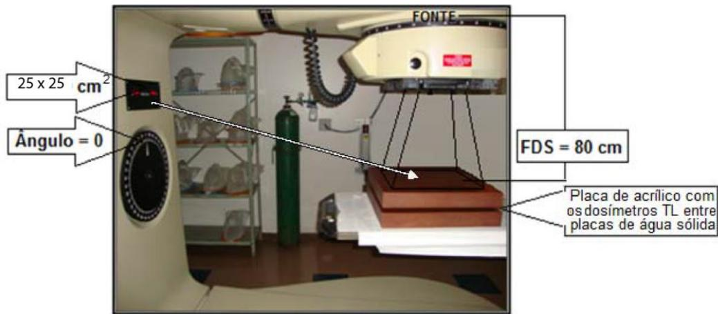
**Figura 19:** Geometria de irradiação dos dosímetros TL para seleção- *Theratron-780C*.
