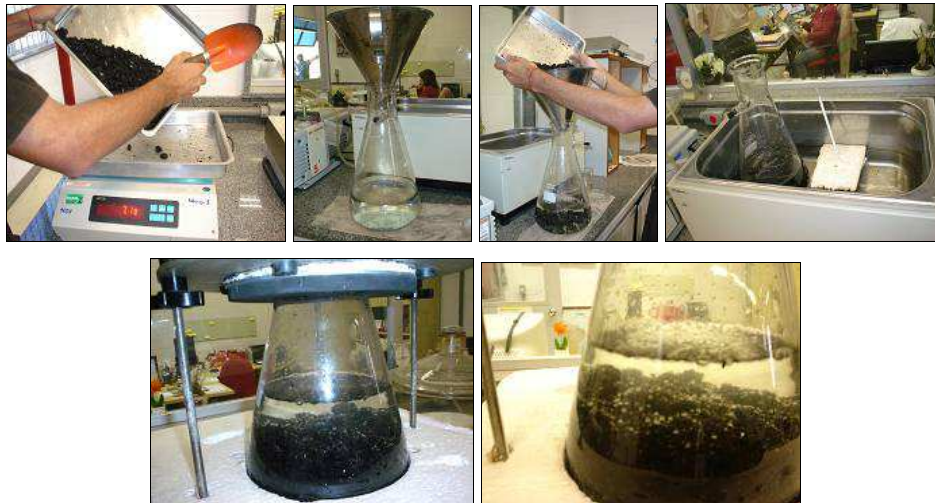
Figura 2.25: Ensaio Rice de determinação da densidade máxima de misturas não compactadas.
