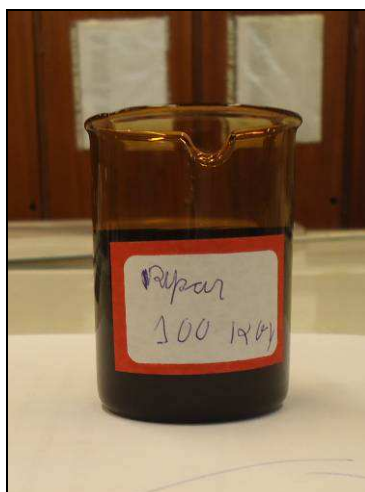
Figura 3.7: Béquer utilizado para armazenar e irradiar o ligante asfáltico para os ensaios de viscosidade deste estudo.
