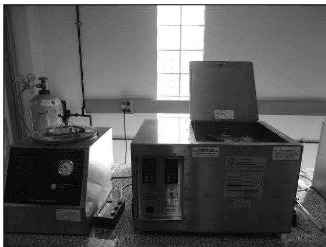
Figura 2.9: Foto do equipamento Vaso de Pressão de Envelhecimento – PAV da PEC/COPPE/UFRJ.
