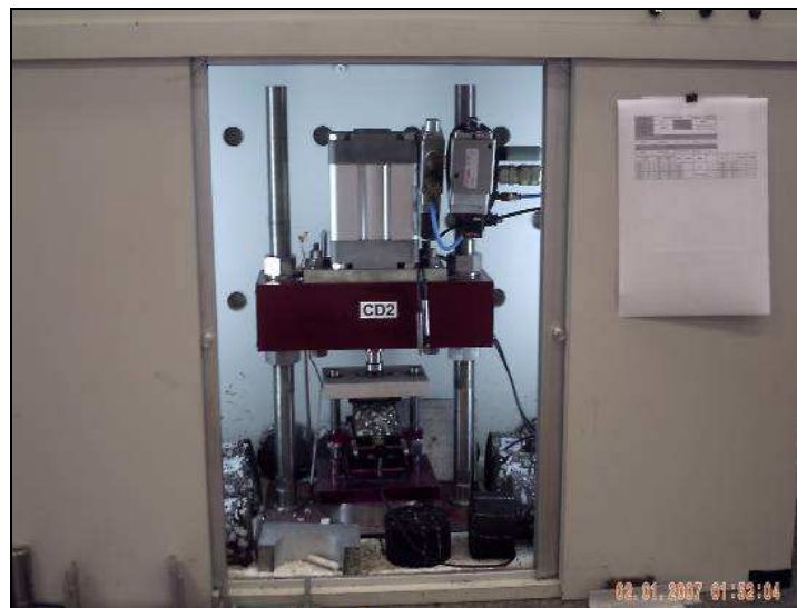
Figura 3.3: Equipamento desenvolvido na COPPE/UFRJ para realização do ensaio de módulo de resiliência de misturas asfálticas, usado na presente pesquisa.
