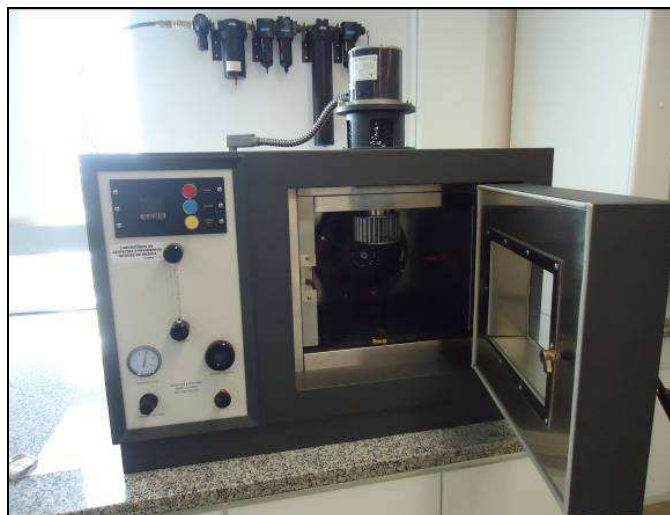
Figura 2.8: Foto da estufa de película delgada rotacional (RTFOT) da PEC/COPPE/UFRJ.
