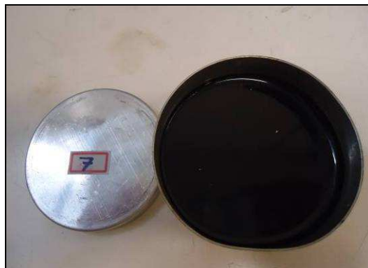
Figura 3.5: Cápsula utilizada para realizar o ensaio de penetração e a irradiação nesta pesquisa.
