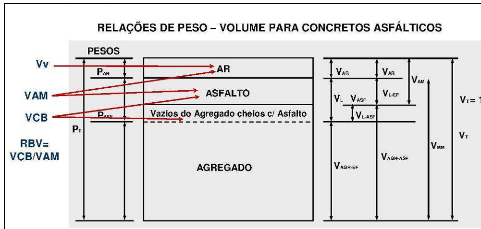
Figura 2.24: Ilustração da volumetria em uma mistura asfáltica (BERNUCCI et al. , 2010).
