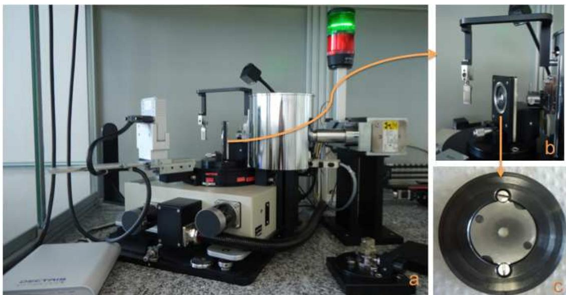
Figura III.11 – (a) Difratômetro da marca STOE, modelo STADI P, em geometria de transmissão; (b) destaque para o porta-amostra que é mantido em rotação durante a aquisição dos dados e; (c) amostra acondicionada entre duas folhas de celulose-acetato.
