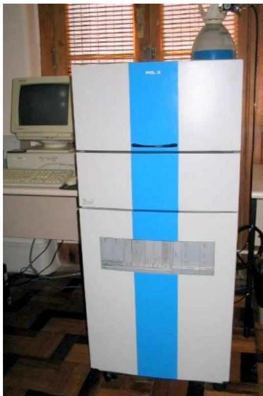
**Figura 3.12** - Leitora de TLDs Fimel PCL3.
