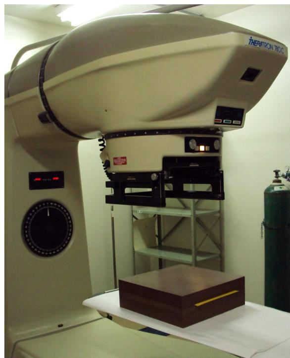
**Figura 3.10** - Arranjo experimental para irradiação do filme dosimétrico X-OMAT V.
