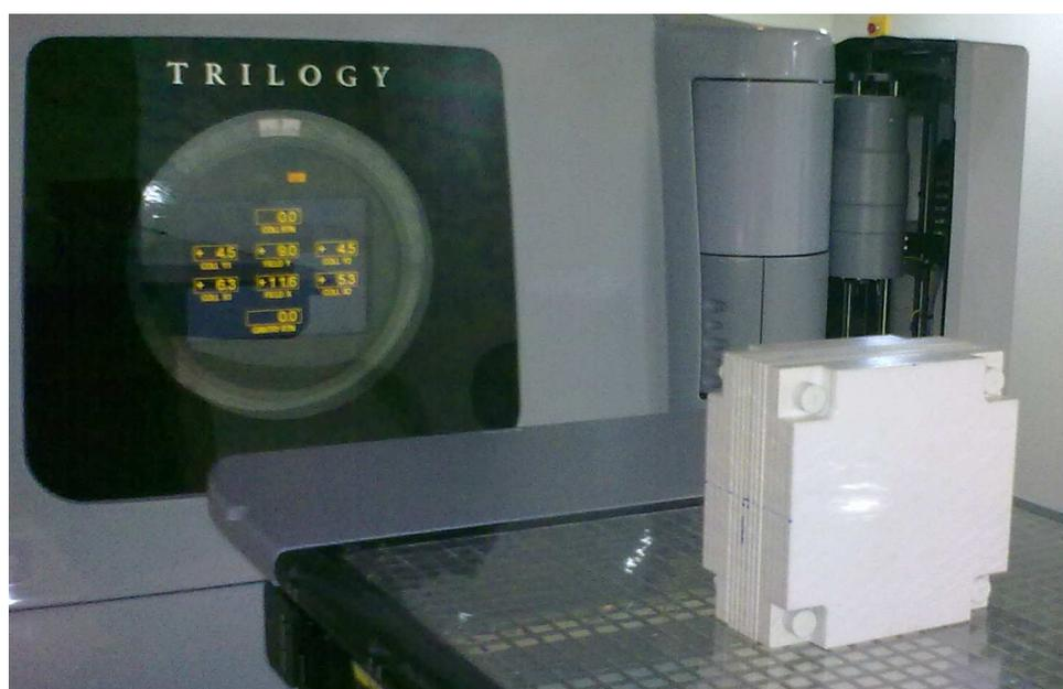
**Figura 4.14** - Versão final do protótipo do objeto simulador para controle de qualidade em IMRT.
