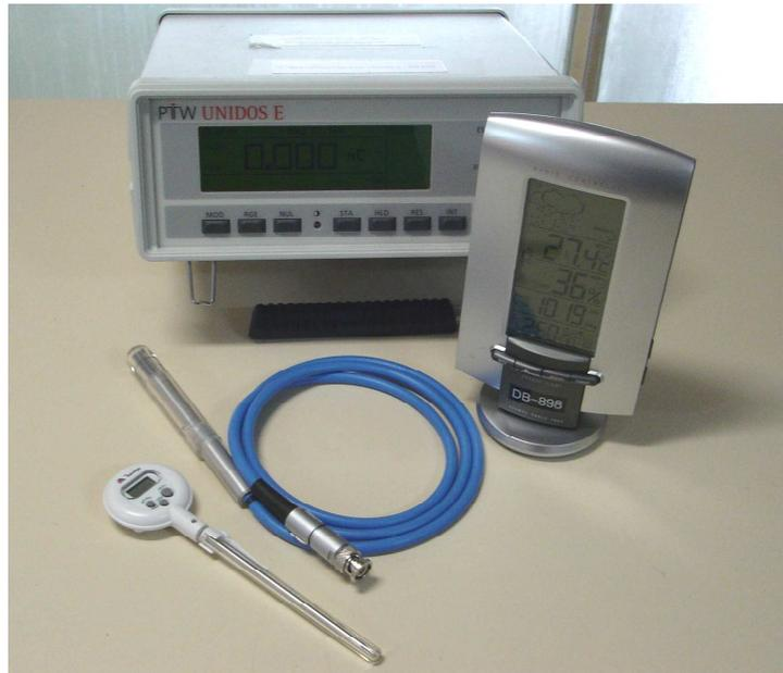
**Figura 3.6** - Conjunto dosimétrico de referência (eletrômetro e câmara de ionização cilíndrica), termômetro e barômetro digitais.
