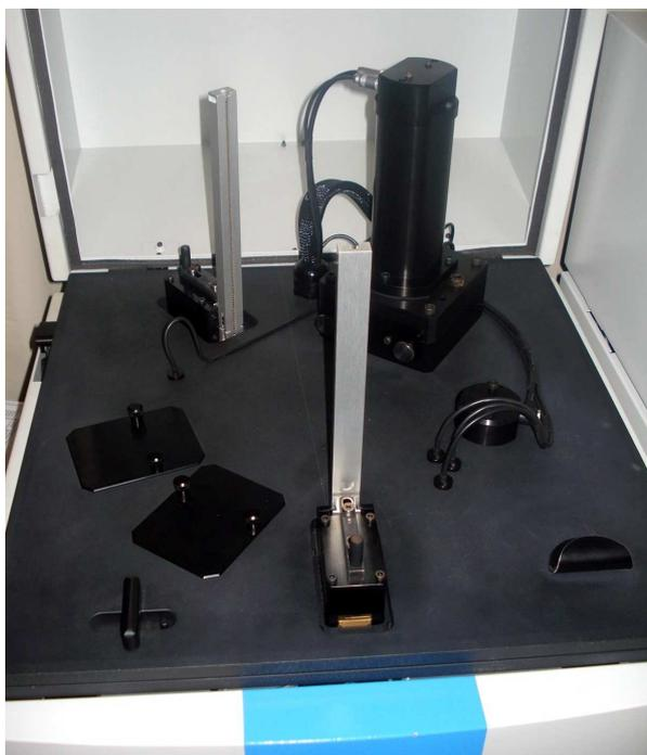
**Figura 3.14** - Visão superior interna da leitora Fimel PCL3 onde aparecem o descarregador (esquerda), o carregador (centro) e a fotomultiplicadora (direita).
