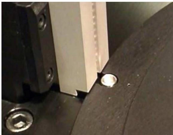
**Figura 3.13** - Copela liberada pelo carregador no disco giratório.
