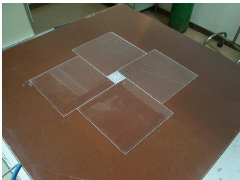
**Figura 3.15** - Arranjo experimental da irradiação dos TLDs para seleção.
