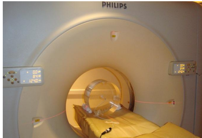
Figura 3.10 Posicionamento do simulador no gantry do tomógrafo
