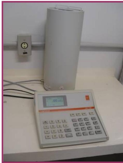
Figura 4.6 Ativímetro CRC-15R em uso no LNMRI.
