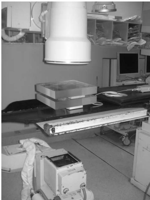
**Figura 5.** Arranjo experimental para medida de taxa de kerma no ar na entrada do intensificador de imagem, taxa de kerma no ar de entrada na superfície e qualidade da imagem.
