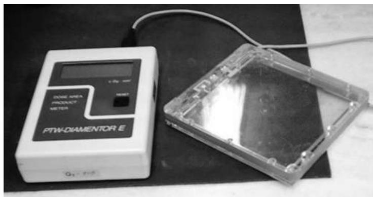
**Figura 5.5.** Diamentor E: eletrômetro e câmara de ionização.
