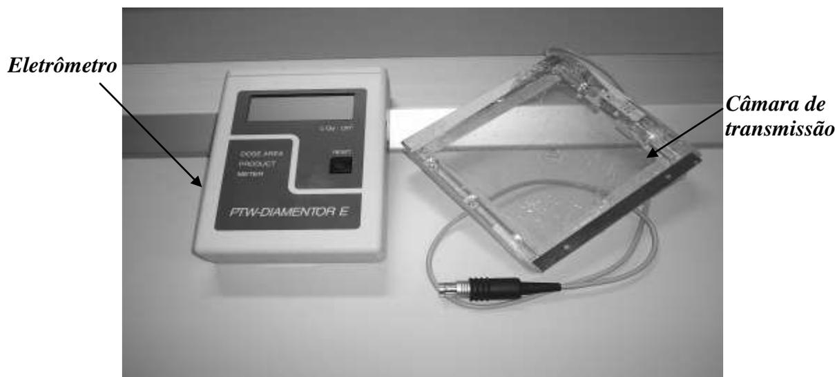
**Figura 3.5.** Diamentor E e câmara de transmissão (PTW, Alemanha).
