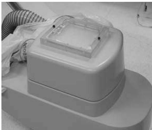
**Figura 3.4.** Câmara de transmissão de grande-área posicionada na saída do tubo de raios X.
