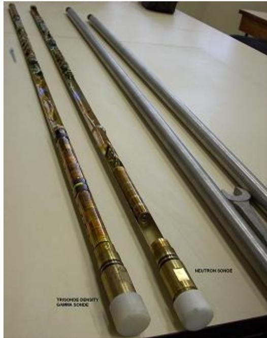
Figura IV.2: Fotografias das ferramentas de perfilagem Trisonde Density Sonde e Neutron Sonde
