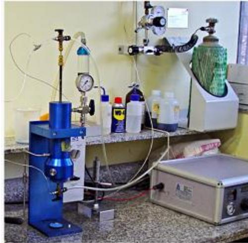
Figura IV.14: Ilustração do porosímetro Ultra poro perm's 500 [89]
