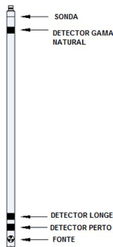
Figura III.22: Desenho esquemático de uma ferramenta de densidade
