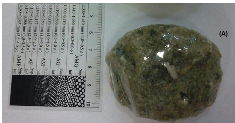
Figura A.4: ITAB-08, amostra retirada a 11,6 m de profundidade.
