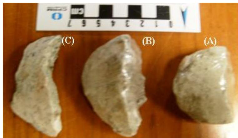
Figura A.2: (A) ITAB-04, amostra retirada a 7,7 m de profundidade, (B) ITAB-05, amostra retirada a 9,0 m de profundidade e (C) ITAB-06, amostra retirada a 9,5 m de profundidade.
