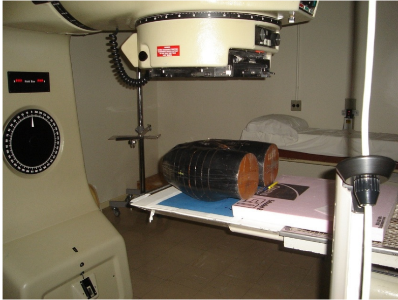
Figura 2.7 – 7: Utilização apenas da região pélvica do Simulador Antropomórfico RANDO Alderson.
