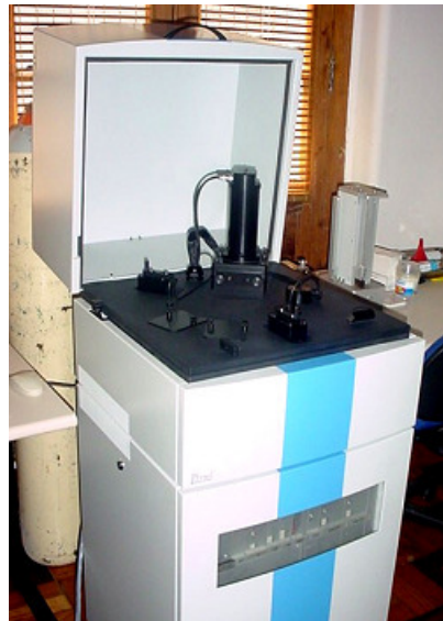
Figura 3.1 – 2: Leitora automática PCL3 utilizada nas leituras dos dosímetros TL.
