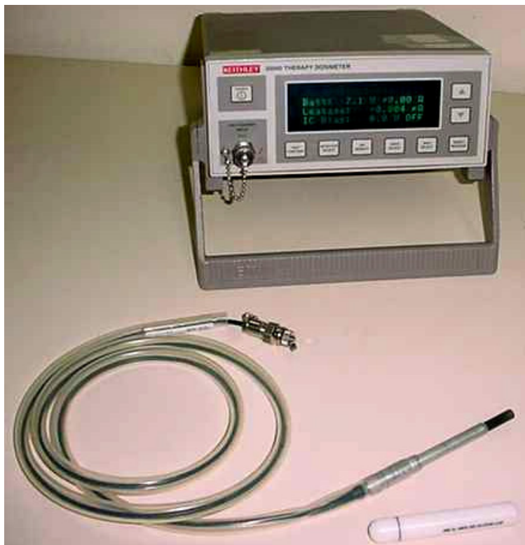
Figura 3.2-8: Conjunto dosimétrico de referência: câmara de ionização IC70 e eletrômetro.
