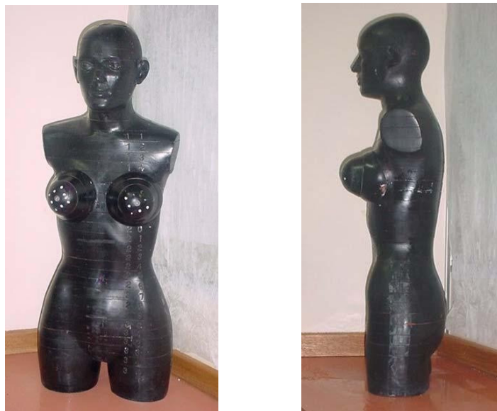
Figura 3.3-2: Simulador Antropomórfico RANDO Alderson Feminino Utilizado, Frente e Perfil.
