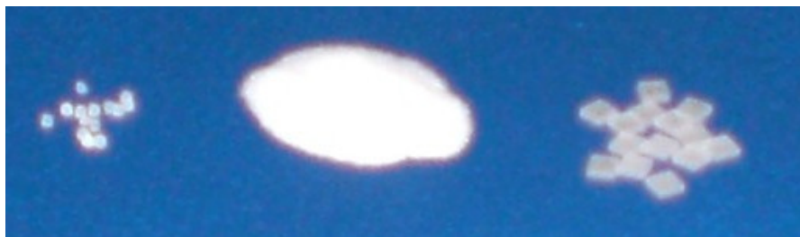
Figura 2.3–3: Diferentes tipos de TLDs: micro-cubos (esquerda), pó (centro) e pastilhas (direita).
