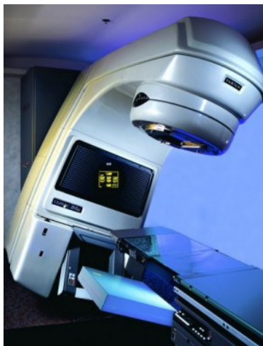
Figura 2.5.2: Irradiador com o gantry inclinado em 15°.
