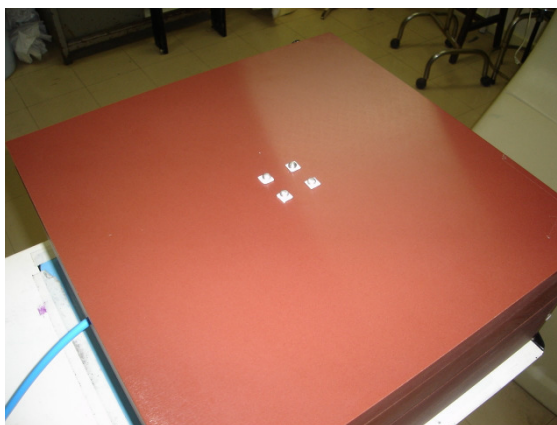
Figura 4.1-3: Setup de calibração para determinar o F_{cal} dos TLD.
