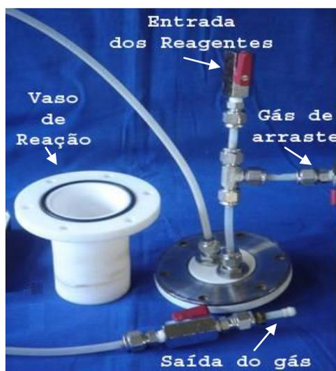
Figura III.3 – Unidade compacta para produção dos radiotraçadores gasosos.
