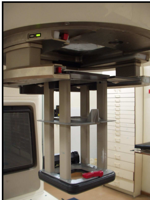
Figura 5: Aplicador utilizado para a colimação de elétrons no acelerador linear da Varian Medical Systems .
