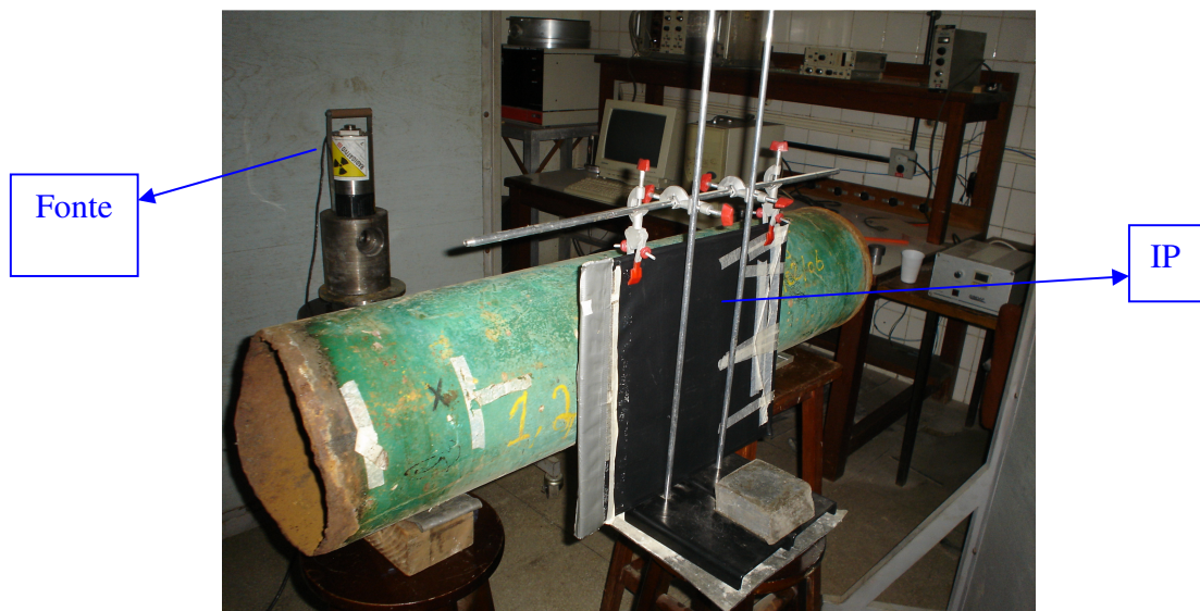
Figura 4.7: Arranjo experimental de radiografia.
