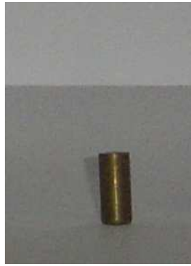
Figura IV.6 – Fonte de nêutrons de ^{252}\text{Cf}(f,n)
