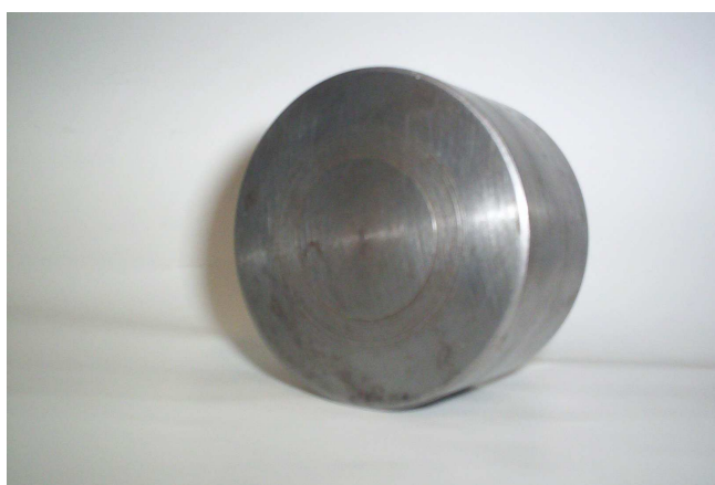
Figura IV.5 – Fonte de nêutrons ^{238}\text{PuBe}(\alpha, n) de 1850 GBq
