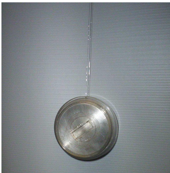
Figura IV.9 – Fonte de ^{238}\text{PuBe}(\alpha, n) de 1850GBq no sistema de imersão
