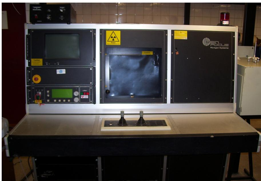
**Figura 3.18** – Equipamento de raios X microfoco.
