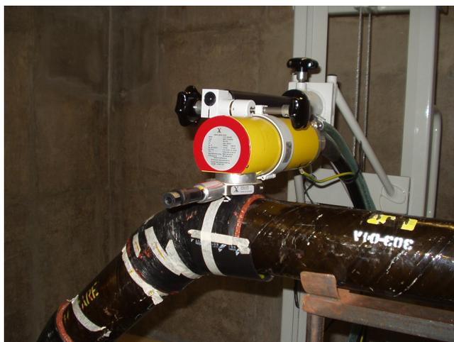
**Figura 3.22** – Geometria de exposição Parede Dupla Vista Simples (PDVS).
