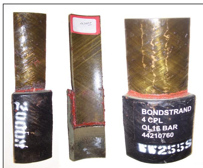
**Figura 3.17** – Corpos de Prova de 4 polegadas com contraste.
