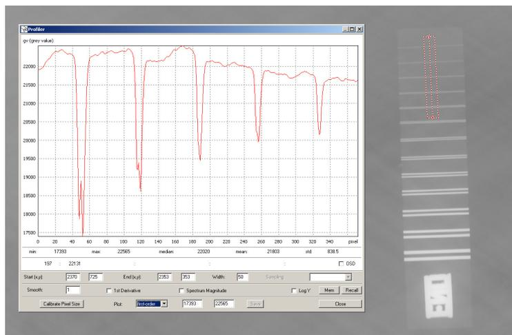
Figura 4.3 – Imagem e perfil do IQI de fio duplo para a tensão de 80 kV.
