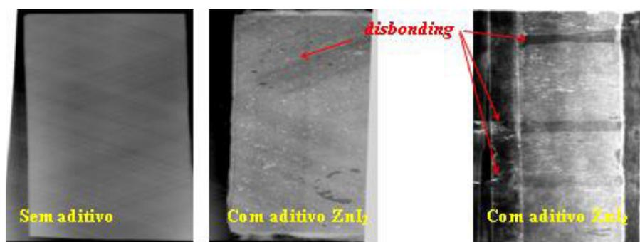
**Figura 2.38** – Detecção de áreas de *disbonding* graças a adição de  $ZnI_2$  no adesivo (MARINHO *et al.*, 2009).
