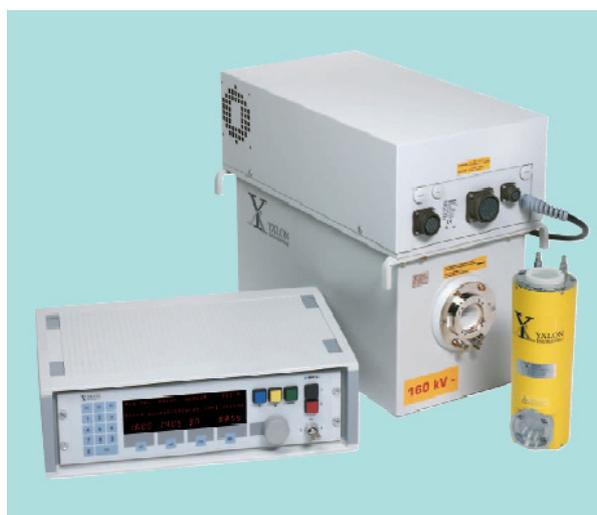
**Figura 3.21** – Aparelho de raios X utilizado na inspeção do circuito hidráulico.
