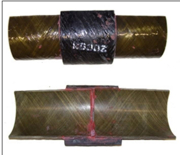
**Figura 3.7** – Corpo de prova com defeitos inseridos.
