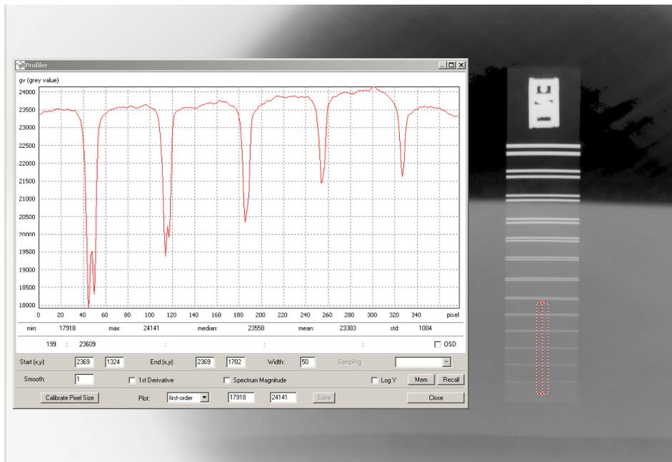
**Figura 4.27** – Imagem e perfil do IQI de fio duplo para a tensão de 80 kV.
