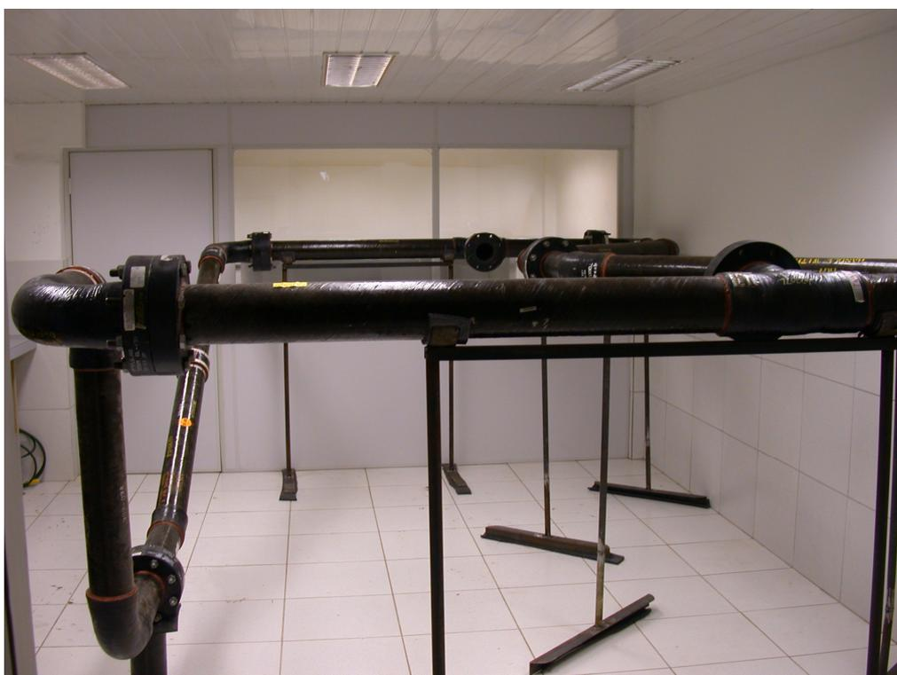
**Figura 3.19** – Circuito hidráulico montado para os ensaios.
