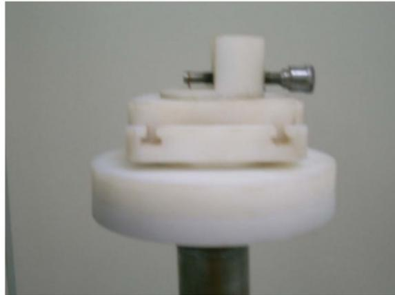
Figura 3.1: Dispositivo de posicionamento das esferas.
