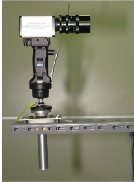
Figura 20: Câmera digital fixa na ponta do suporte.
