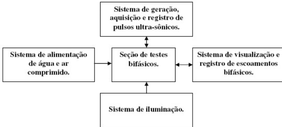
Figura 4.1: Diagrama da planta da seção de testes
