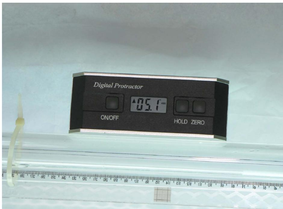
Figura 19: Medidor de inclinação com a seção de testes inclinada a  $+5^\circ$ .
