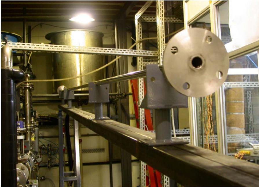
Figura 16: Detalhe da pré-montagem de parte da seção de testes localizada a frente do circuito de água.
