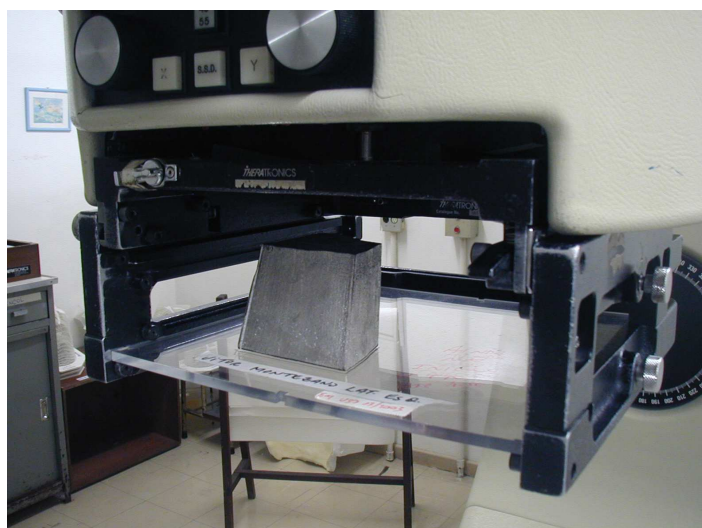
Figura 1.13. Bloco de chumbo colado numa bandeja lisa e fixado no colimador num aparelho de ^{60}\text{Co} .
