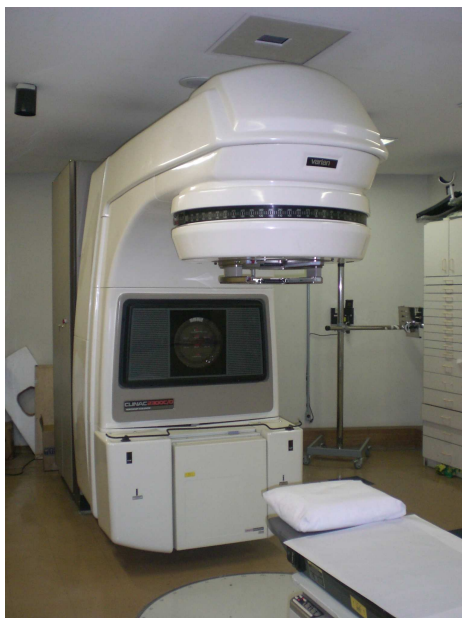
Figura 2.6. Acelerador clínico para uso em tratamentos com feixes de fótons e elétrons.
