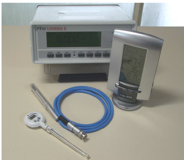
Figura 2.4. Conjunto dosimétrico, termômetro e barômetro usado nas dosimetrias de referência.
