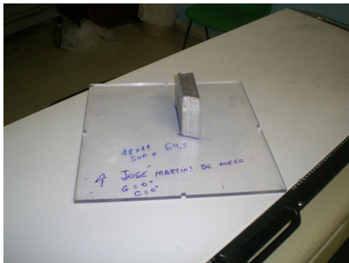
Figura 1.14. Bandeja lisa personalizada com modificador do feixe específico para um tratamento.
