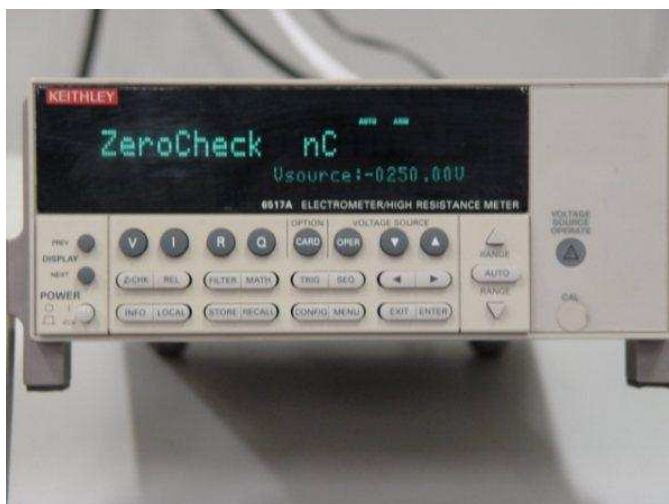
Figura III. 3: Eletrômetro acoplado à câmara padrão nacional do LNMRI/IRD/CNEN.
