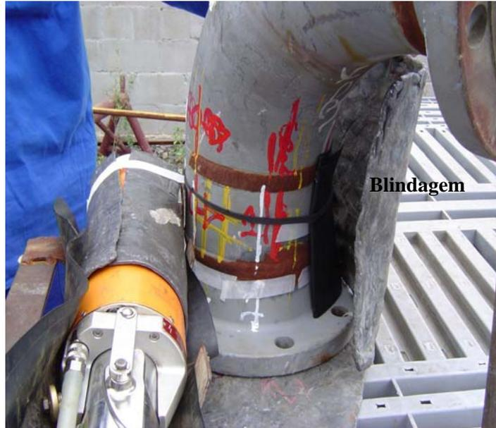
FIG. 3.8 - Exemplo de arranjo para a técnica radiográfica PD-VS.
