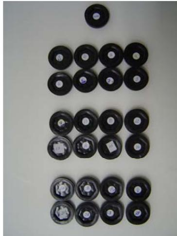
FIG. 3.2 – Vinte e cinco monitores, cada um contendo cinco dosímetros TLD, utilizados nos experimentos na REFAP S/A.
