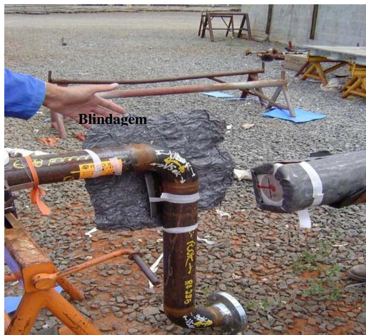
FIG. 3.7 - Exemplo de arranjo para a técnica radiográfica PD-VD.
